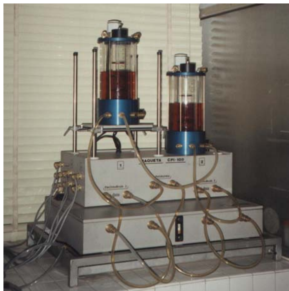
figura 1 : Planta de tanques interconectados. Maqueta ALECOP.
