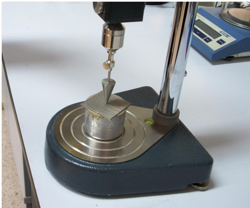
Se colocan las muestras de suelo en los recipientes y se calibra el penetrómetro con la chapa metálica
