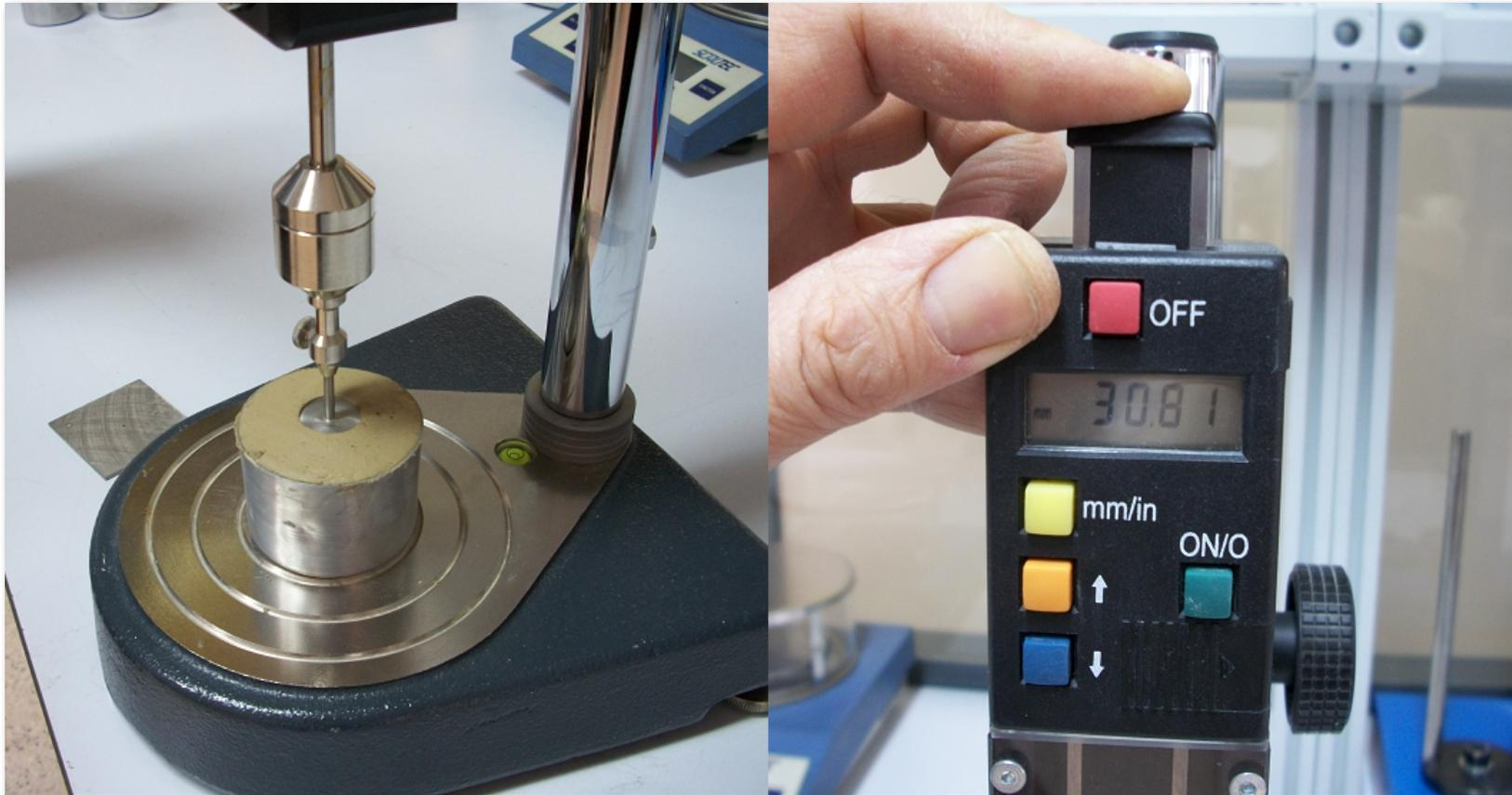
Se procede a ensayar la muestra 3 y se obtiene su penetración ( $P_3$ ) y su humedad ( $W_3$ )
