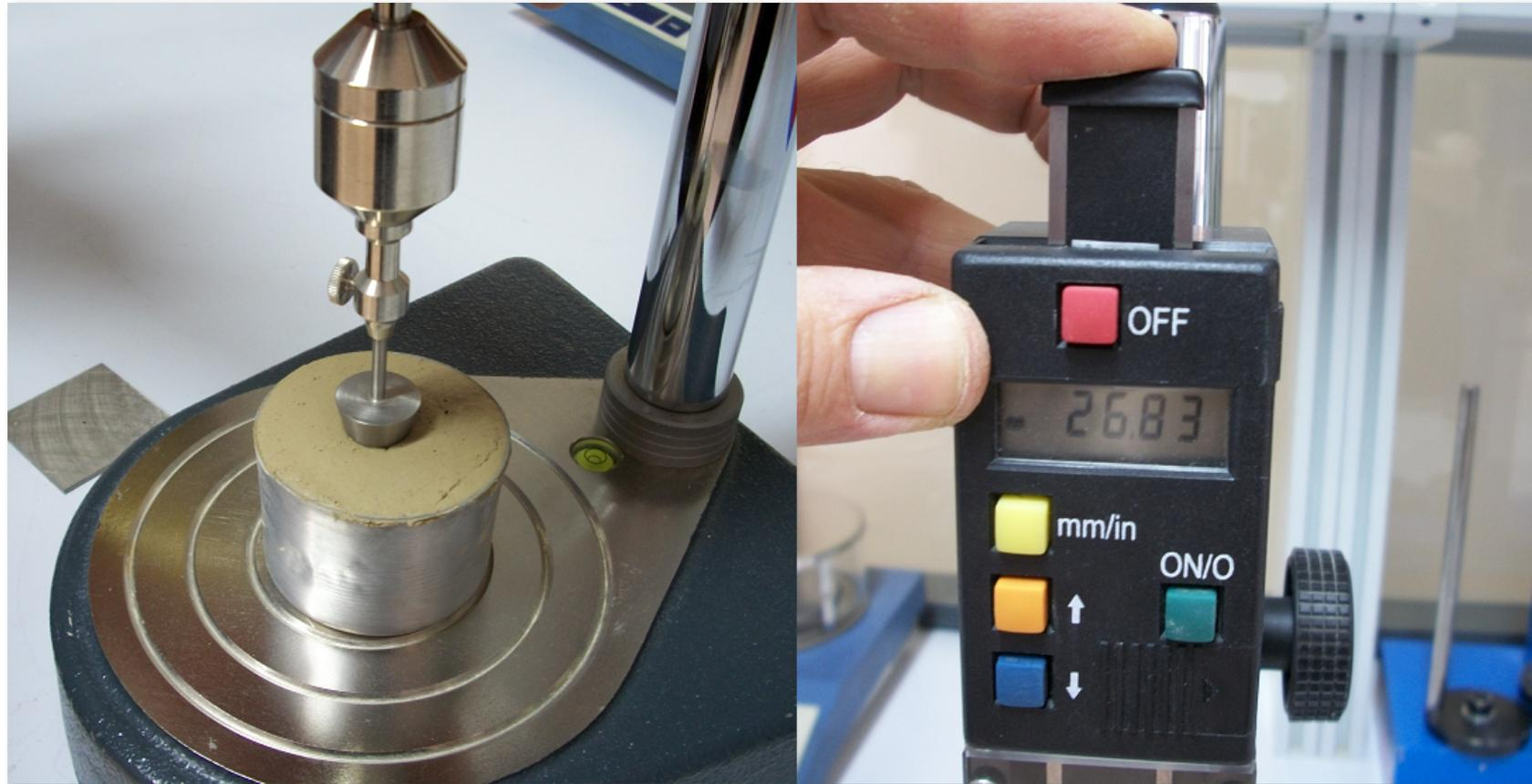
Se ensaya la muestra 2 y se obtiene su penetración ( $P_2$ ) y su humedad ( $W_2$ )
