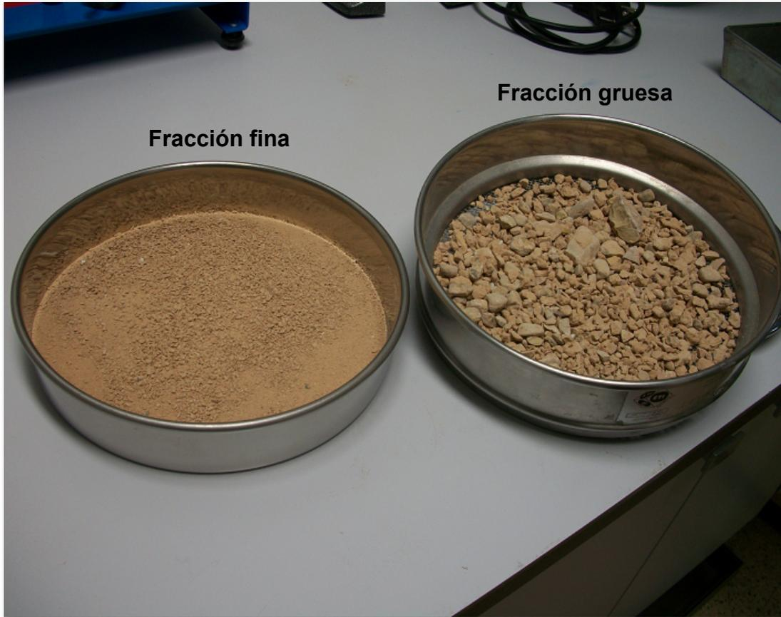
Una vez tamizados se disponen de tres fracciones diferentes: la muestra de finos (pasa el tamiz 2' 00 mm) y gruesos (la que no pasa el tamiz 2' 00 mm) que a su vez se separa en fracción >20 mm y < 20 mm.
