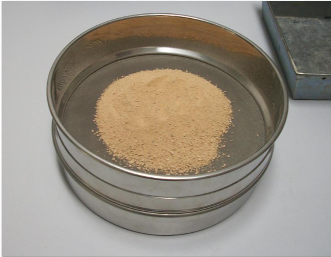
**Fracción granular fina.** De forma idéntica se realizaría el ensayo para partículas finas con los tamices de 1'25, 0'40, 0'16 y 0'08 mm anotando los pesos retenidos (R) por cada tamiz ( $\emptyset$ ).
