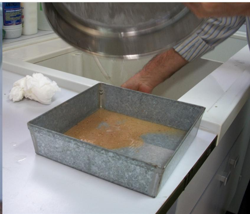
Pasadas unas 24 horas se pasa por el tamiz 0'08 mm y se decanta en una bandeja
