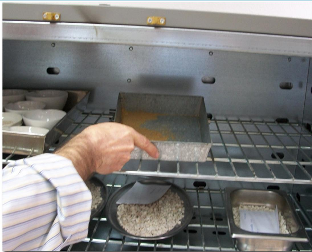
Se introduce en el horno a 60°C para secar la muestra y así obtener la cantidad de finos del suelo
