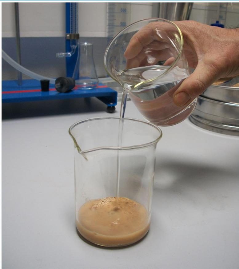
Se mezcla en el vaso de precipitados con la muestra y se añade agua destilada hasta 5 cm del borde
