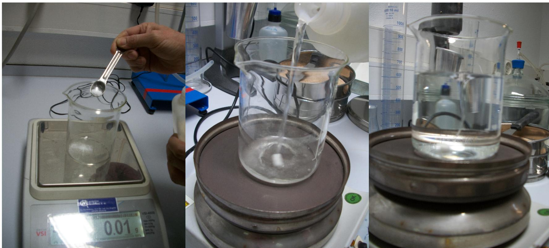
Se diluye una cucharada de Hexametáfosfato sódico en 125 ml de agua destilada y se agita con el agitador
