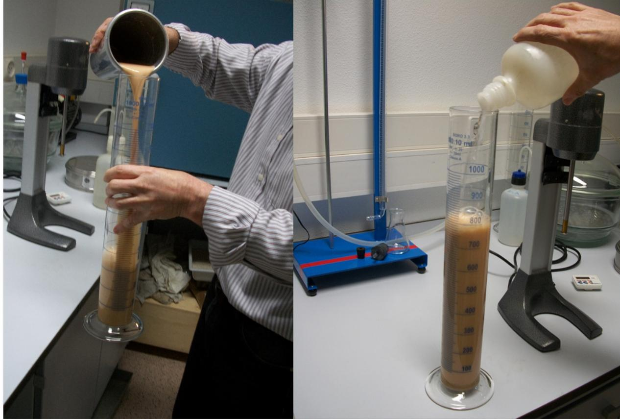
Inmediatamente se pasa la dispersión preparada a la probeta graduada y se añade agua destilada hasta completar 1 litro
