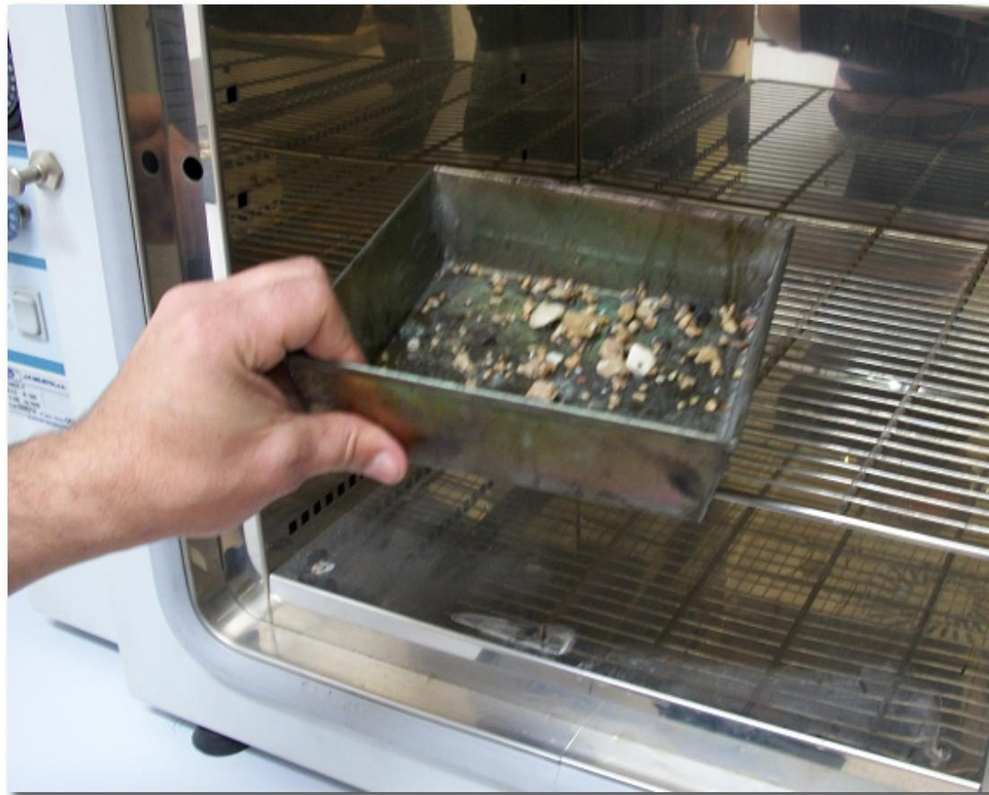
Se introduce en el horno a 60°C para secar la muestra y así obtener la cantidad de gruesos del suelo
