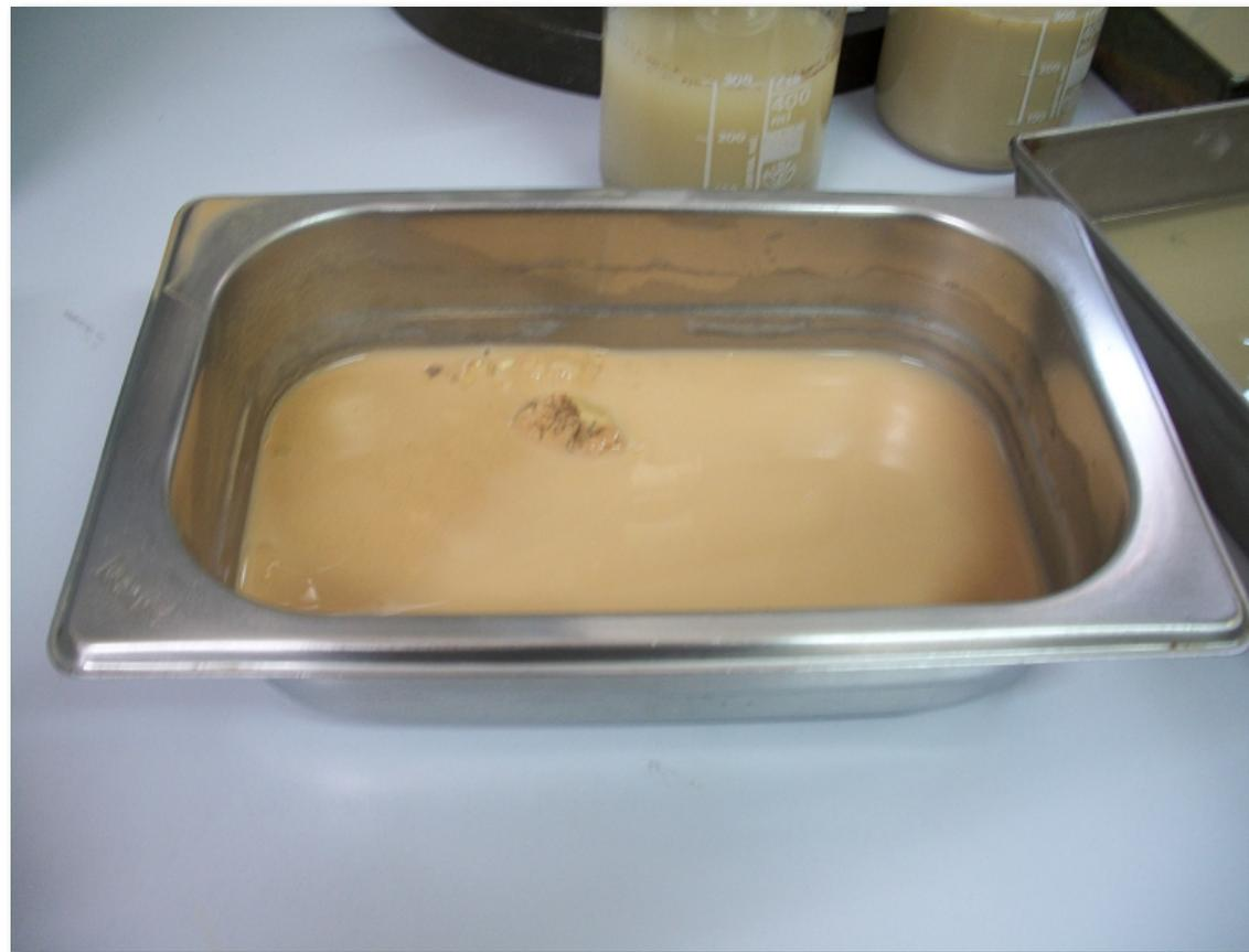
Se diluye con agua y se introduce una cucharada de hexametáfosfato sódico, dejándolo actuar 24 horas
