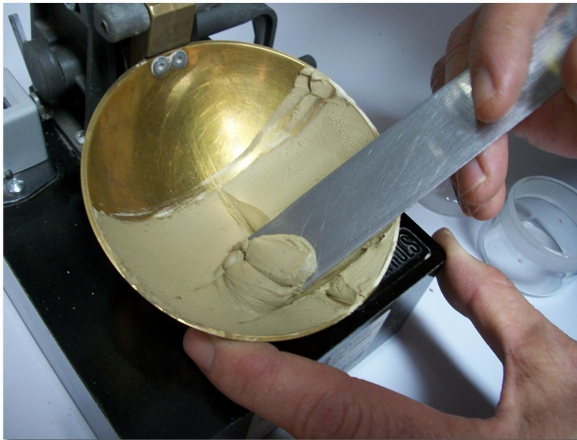
Se extrae una muestra de 10-15 gr de la zona de unión para obtener la humedad ( $W_i$ ).
