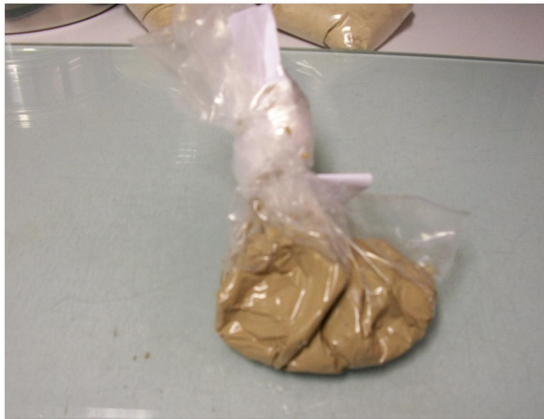
Se deja la muestra a ensayar durante 2 horas en cámara húmeda
