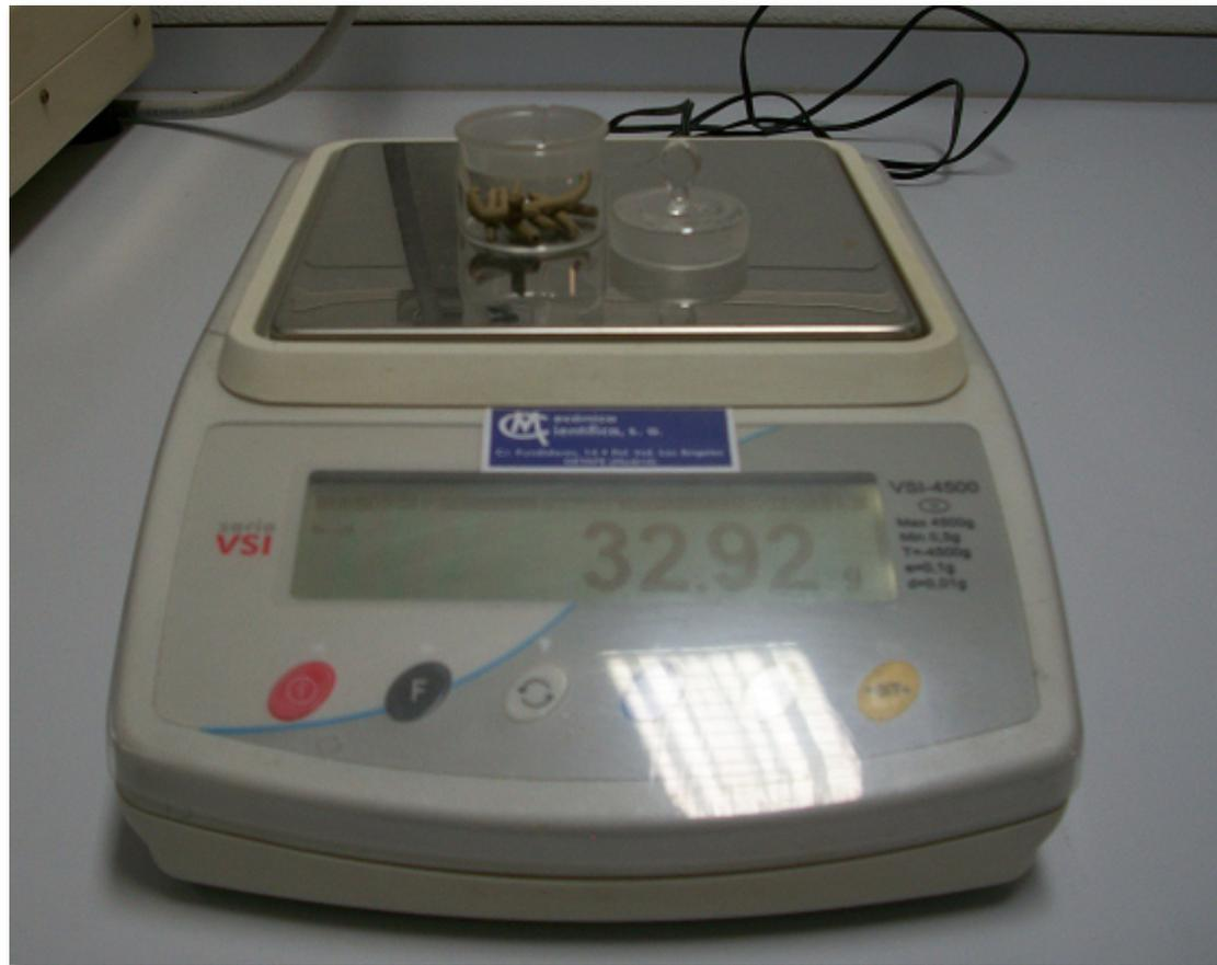
Se colocan los cilindros en el pesasustancias y se pesan (WI)
