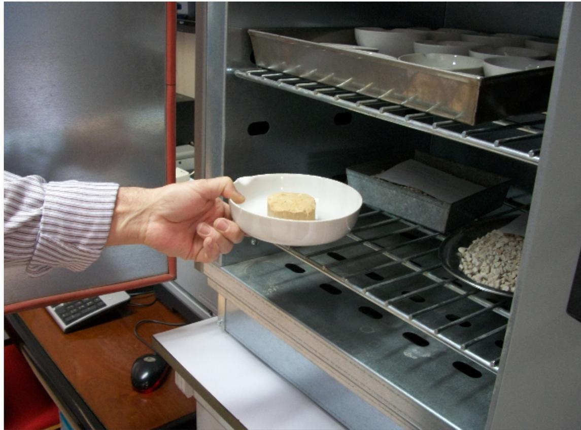
Se lleva la tara a un horno durante un periodo de 24 horas a una temperatura entre los 105°C y 115°C
