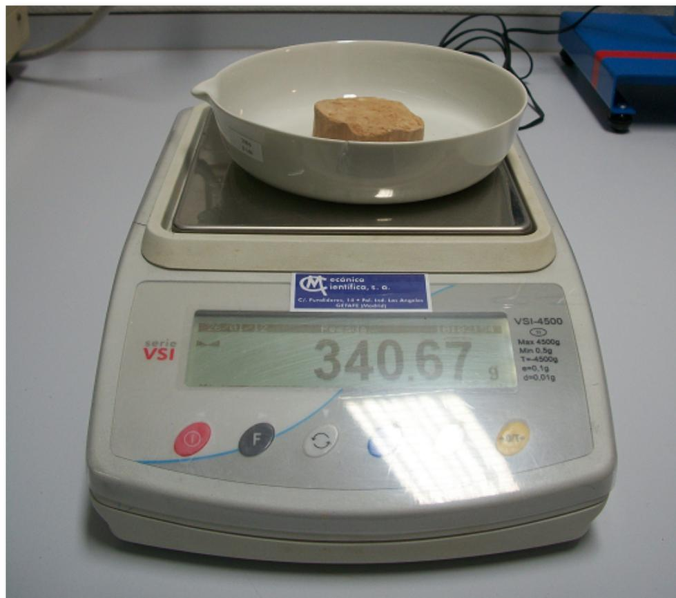
Se saca la muestra del horno y se vuelve a medir su masa en seco (WS)
