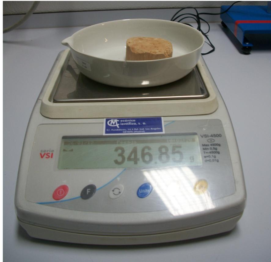
Se coloca la muestra en una tara y se mide su peso con la ayuda de una balanza (WT)
