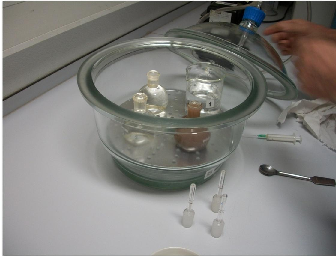
Se introduce el picnómetro lleno hasta la mitad en la campana de vacío con el fin de eliminar las burbujas de aire que puedan haber quedado ocluidas entre las partículas del suelo
