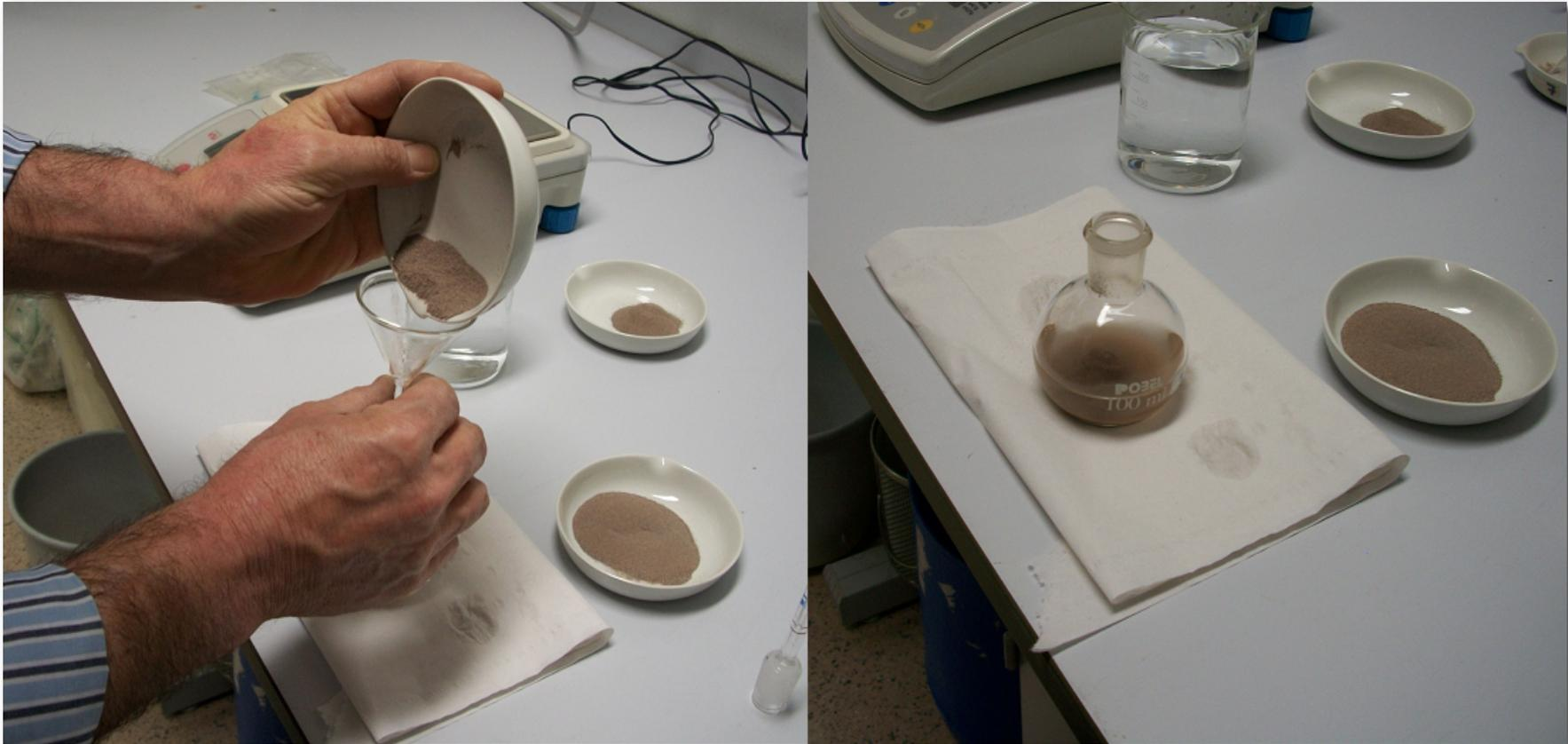
Con la ayuda de un embudo se introducen los 15 g de suelo y se determina de nuevo la masa M3
