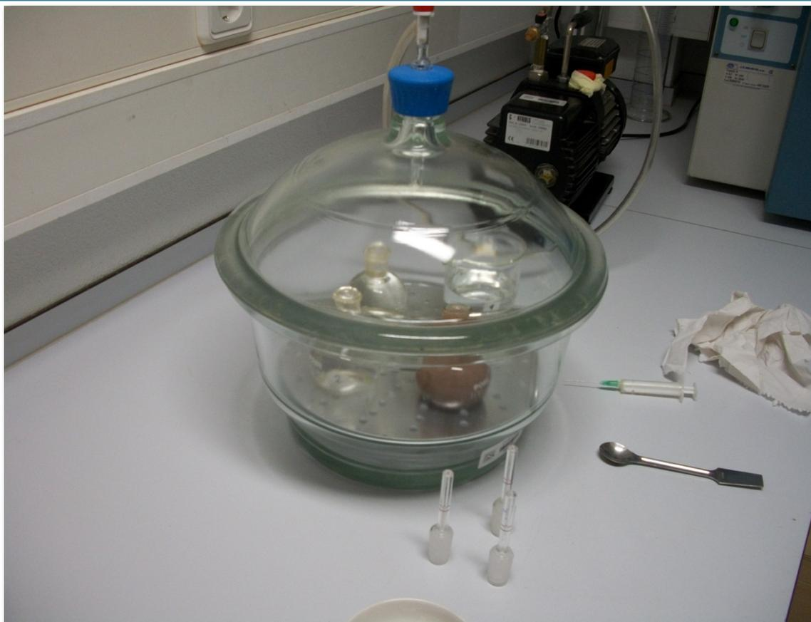
Se vuelve a meter en la bomba de vacío para eliminar posibles burbujas
