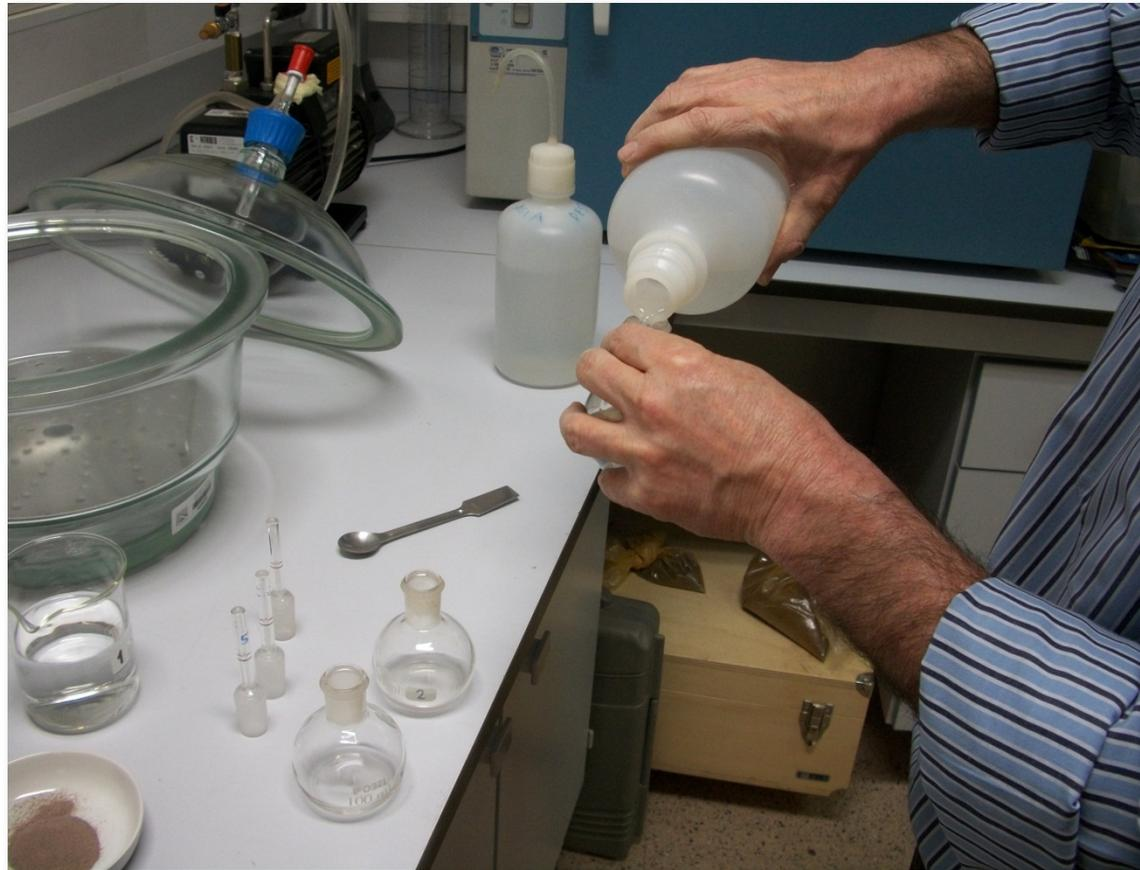
Se referencia un picnómetro y se llena con agua destilada hasta por encima de la línea de enrase
