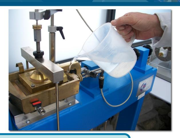
Se llena tan pronto como sea posible con agua destilada hasta el nivel superior de la probeta, y se mantiene así todo el ensayo
