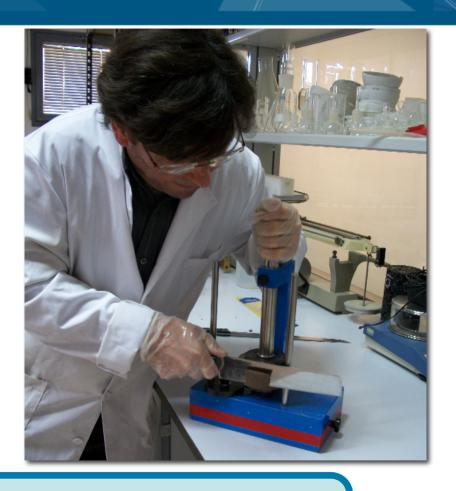
Tallado de 3 probetas del mismo suelo para la realización de los 3 ensayos
