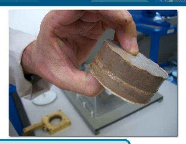
Detalle de la probeta del suelo después del ensayo
