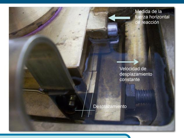
Detalle del desplazamiento entre las dos partes de la caja de corte
