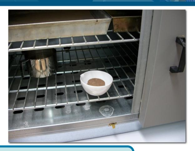
Secamos la muestra en estufa para calcular su humedad final
