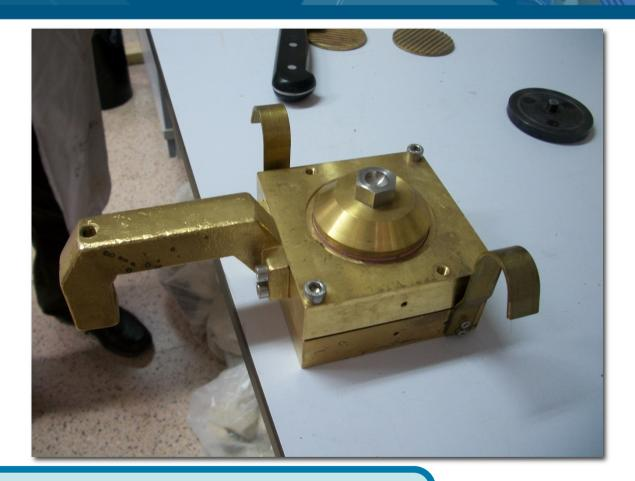
Montamos el pistón de carga, y ya estaría montada la caja de corte
