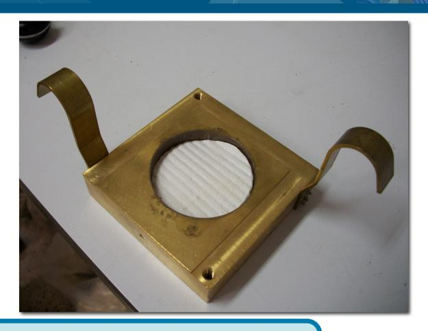
Colocamos el papel de filtro en la parte inferior de la caja, para evitar que se escapen partículas de la muestra durante el ensayo
