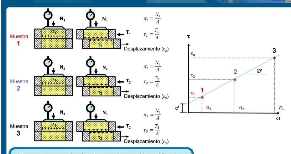
Al romper tres probetas del mismo suelo sometidas a diferentes tensiones normales ( $\sigma_1$ ,  $\sigma_2$  y  $\sigma_3$ ), obtenemos los respectivos valores de resistencia al corte ( $\tau_1$ ,  $\tau_2$  y  $\tau_3$ ) que nos permiten calcular el **ángulo de rozamiento y la cohesión efectivos**.
