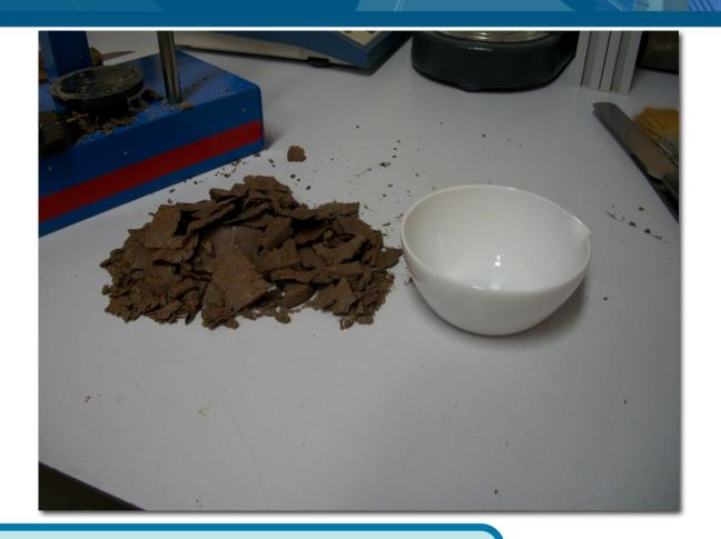
Del suelo sobrante durante el proceso de tallado, se toma una muestra para calcular la humedad natural
