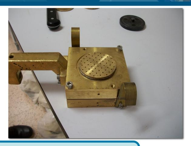
Colocamos la placa perforada para el drenado
