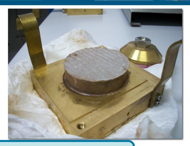
Se desmonta la caja del aparato de corte
