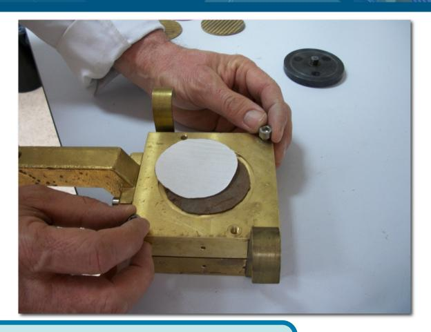
Montamos y fijamos la parte superior de la caja, colocando otro papel de filtro encima de la muestra
