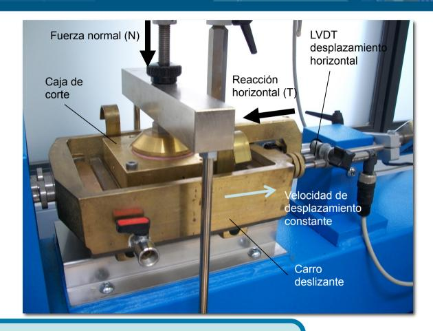
Se coloca la caja montada en el aparato de corte
