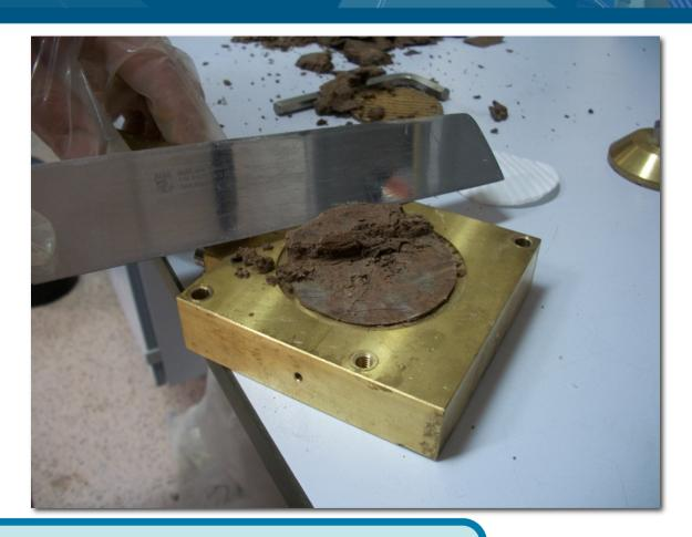
Se coloca la muestra en la caja de corte y se enrasa
