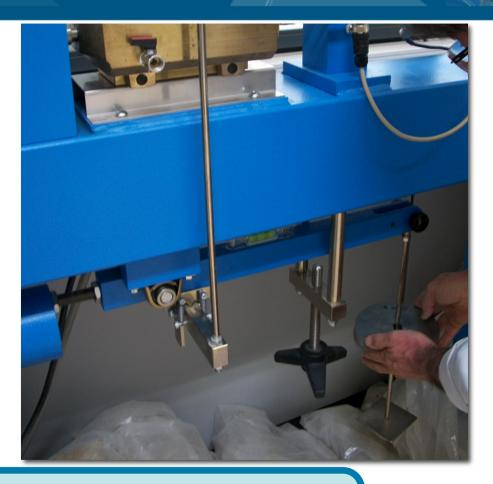
Se colocan las pesas necesarias en el colgadero para conseguir la tensión vertical deseada permitiendo el drenaje libre del agua hasta finalizar el proceso de consolidación primaria del suelo para a continuación iniciar el ensayo.
