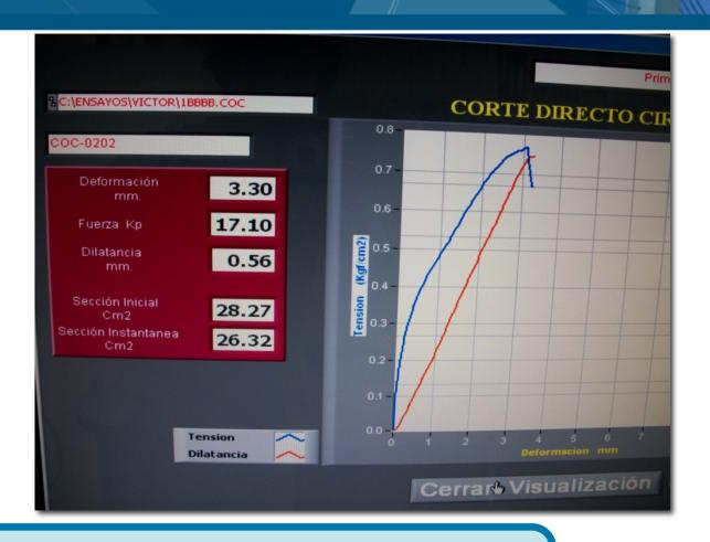
Se pone en marcha el motor. El ensayo continua hasta que la probeta de suelo rompe. La velocidad deberá ser lo suficientemente lenta como para que no se originen presiones intersticiales, permitiendo el libre drenaje del agua de los poros.
