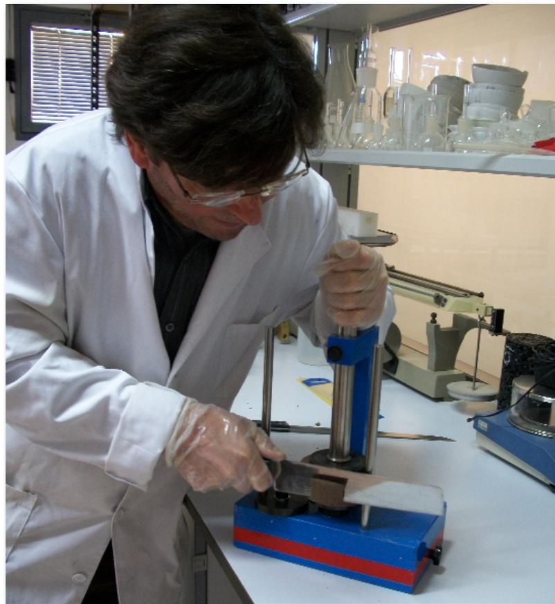
Tallado de 3 probetas del mismo suelo para la realización de los 3 ensayos
