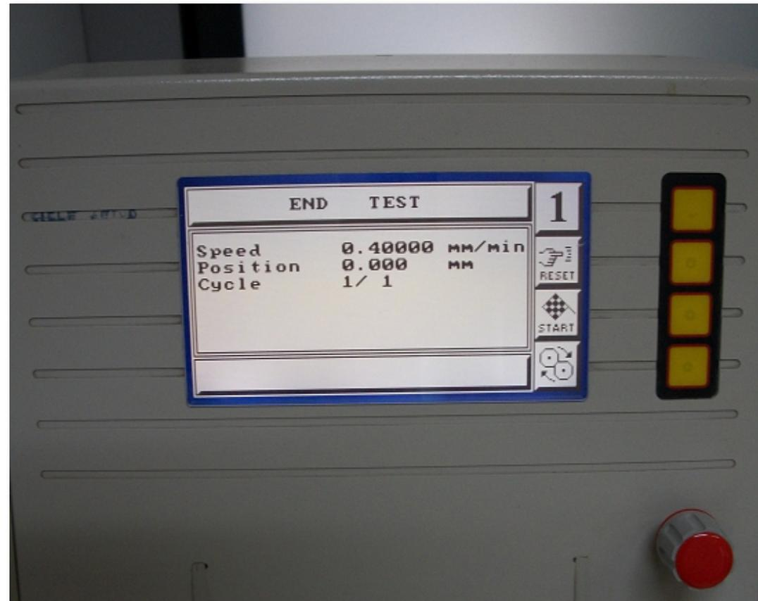
El ensayo se realiza a una velocidad lo suficientemente rápida para que no se produzca el drenaje . La velocidad de corte horizontal apropiada para condiciones no drenadas debe ser entre 0,5 y 1,5 mm/min.
