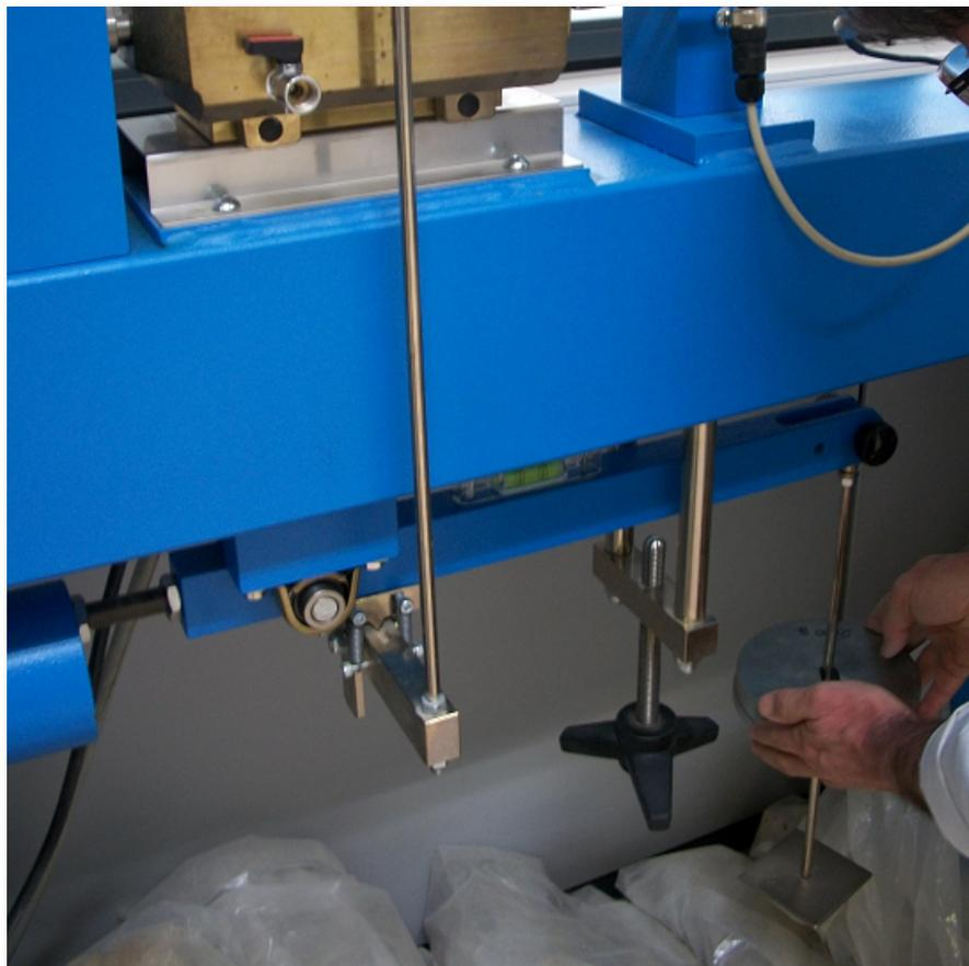
Se colocan las pesas necesarias en el colgadero para conseguir la tensión vertical deseada sin permitir el drenaje libre del agua para iniciar inmediatamente después el ensayo de corte.
