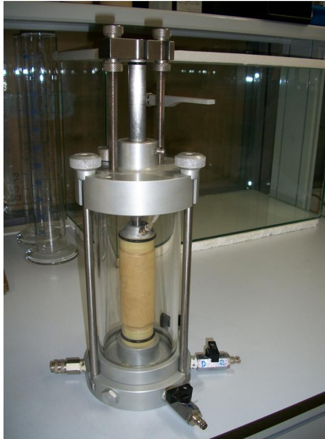
Se monta el resto de la célula triaxial y se fija, asegurando la verticalidad del conjunto
