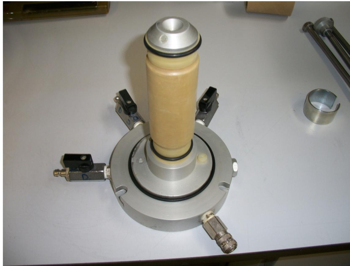
Colocamos el pistón sobre la probeta, cubrimos la muestra eliminando las burbujas de aire que puedan quedar y la fijamos con las bandas elásticas
