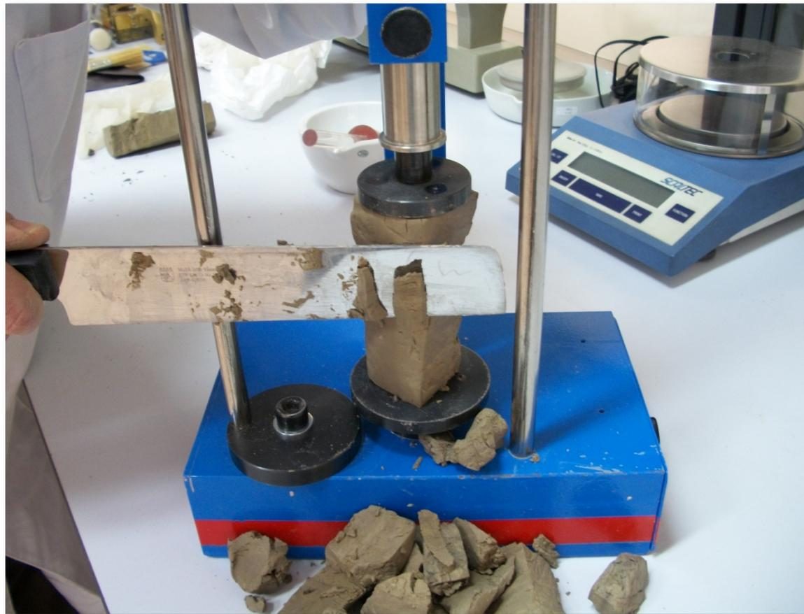
Se procede al tallado de la probeta. Las probetas deben ser de forma cilíndrica con un diámetro no inferior a 35 mm y una altura entre 1,85 y 2,25 veces su diámetro
