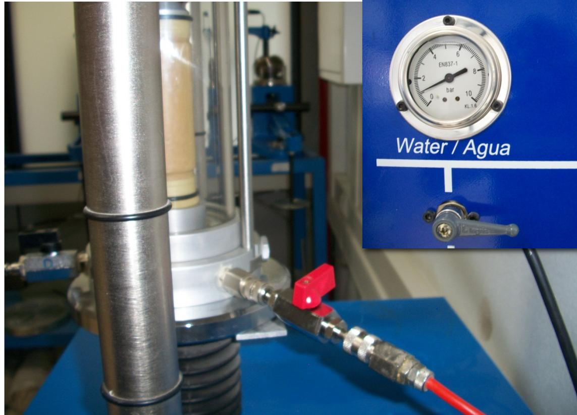
Se realizan todas las conexiones para aplicar las presiones necesarias para el ensayo cerrando la válvula del drenaje que permanecerá cerrada durante todo el ensayo. No se realizará la saturación ni la consolidación de la probeta.
