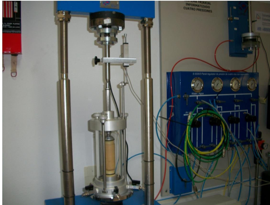
Se llena la célula con agua desaireada dejando salir el aire por el tapón superior, y se monta en el aparato triaxial
