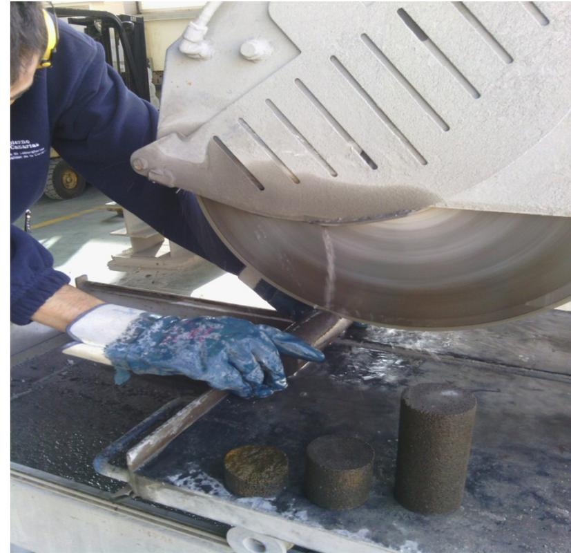
**Corte y preparación.** Las probetas deben ser cilíndricas, con una relación longitud/diámetro superior 1,0 tanto diametral como con anisotropía.
