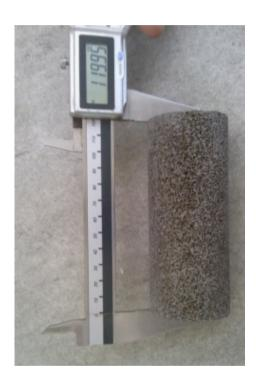
**Dimensionar y pesar**. Se medirán dos diámetros en ángulo recto en la parte superior, media e inferior de la probeta, con un calibrador o pie de rey y se calcula la media. Igualmente se toman medidas de la altura del cilindro. Se pesa el testigo.
