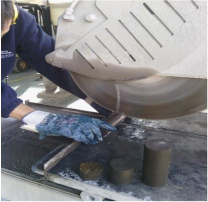
**Corte y preparación**. Las probetas deben ser cilíndricas, con una relación altura/diámetro de 2,5 a 3,0. El diámetro debe ser 10 veces superior al tamaño del grano mayor de la roca y no inferior a 50,0 mm.
