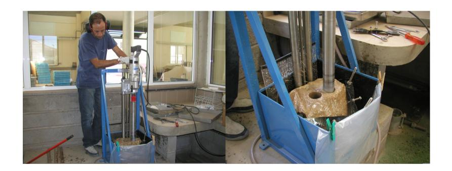
Extracción de probeta cilíndrica para ensayo, a partir de un bloque de roca.
