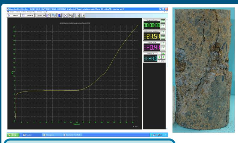
Se anotará la forma de rotura y se tomará una fotografía. La carga máxima registrada en Newtons (o en sus múltiplos) se divide por la sección de la probeta, para obtener la resistencia a compresión uniaxial de la misma, expresada en MPa.
