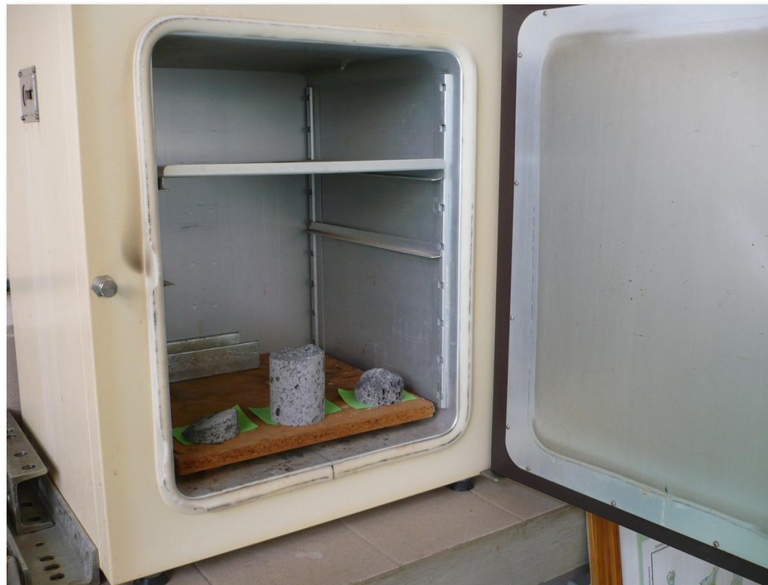
Se seca la muestra en estufa hasta masa constante y se determina su humedad ( $w$ ).
