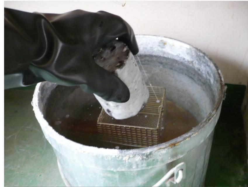
Se obtiene el peso de la muestra con parafina ( $M_2$ ). La diferencia entre  $M_1$  y  $M_2$  nos da la masa de la parafina ( $M_3$ ). El volumen de la parafina ( $V_1$ ) resulta del cociente entre  $M_3$  y la densidad de la misma.
