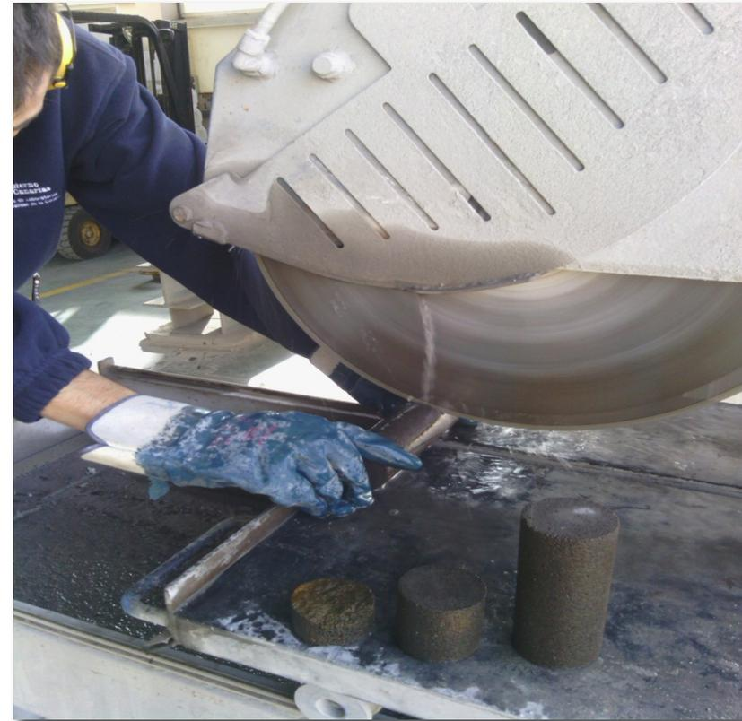
Este ensayo se puede realizar a partir de fragmentos irregulares de roca. Es práctica habitual aprovechar los sobrantes de los cortes de la preparación de testigos de roca para compresión simple.
