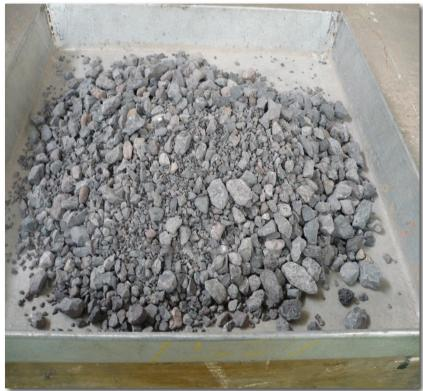
Se seca la muestra, se pesa el material retenido en el tamiz 1,6 mm (m)
