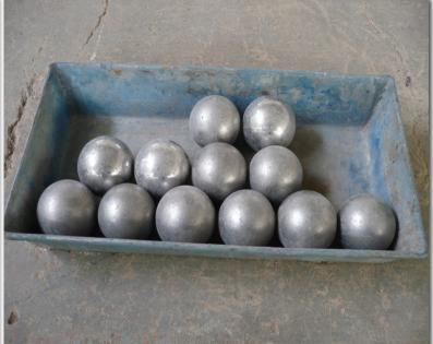
Se vierte la muestra en el tambor del molino de Los Ángeles junto con la carga abrasiva (bolas de acero).
