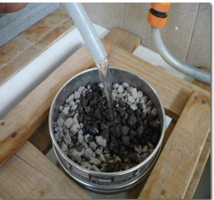
Se obtendrán 5000 gr de muestra, cuya curva granulométrica cumpla que entre el 60 y 70 % del árido deberá pasar por el tamiz de 12,5 mm y entre el 30 y 40 % del árido deberá pasar por el tamiz de 11,2 mm.
