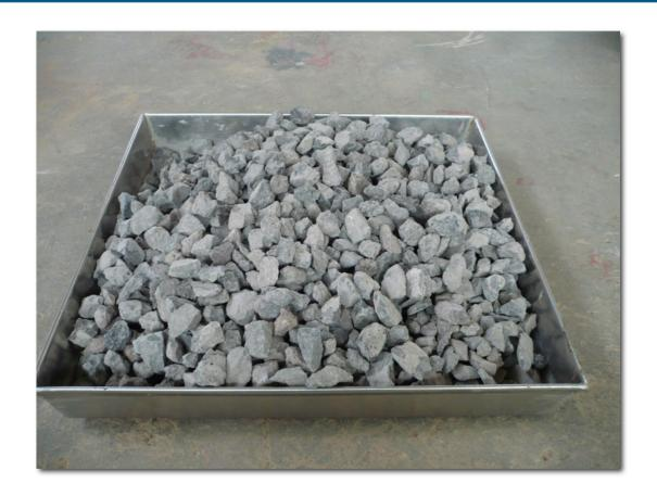
La masa inicial de la muestra será de al menos 15 kg de árido, que pase por el tamiz 14 mm y que retenga en el tamiz 10mm.
