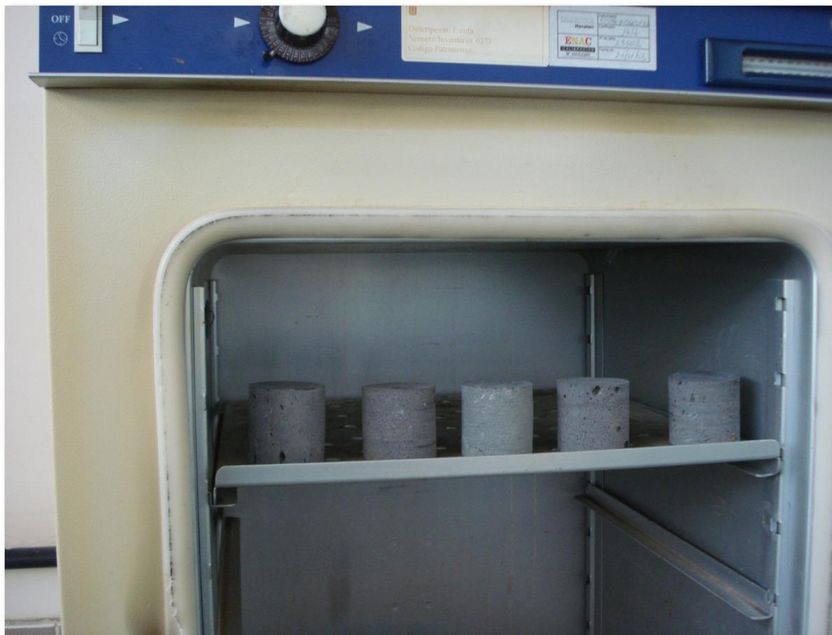
Las probetas se secarán en estufa hasta masa constante
