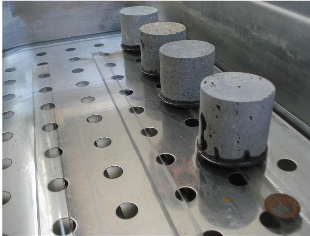
Se vuelven a colocar las muestras dentro del tanque y se continua con el ensayo hasta que la diferencia de dos pesadas consecutivas no sean superior al 1%
