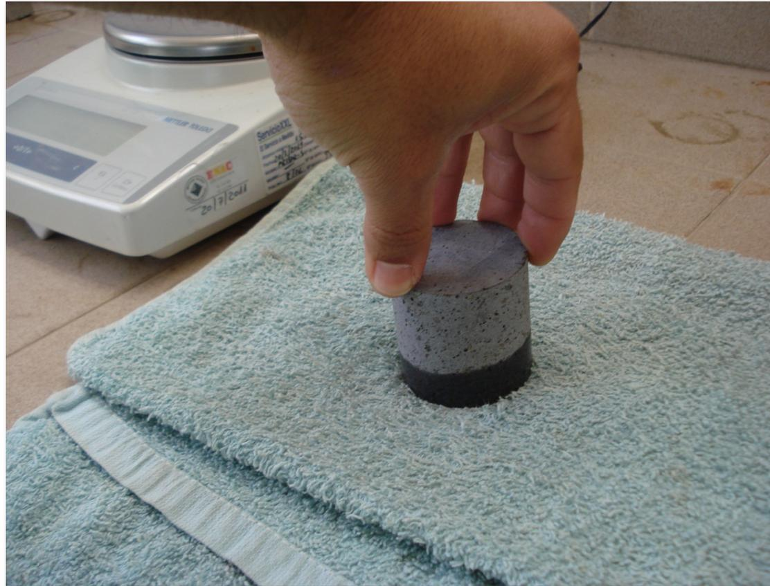
Se sacan las probetas cada cierto intervalo de tiempo y se secan ligeramente con un trapo húmedo
