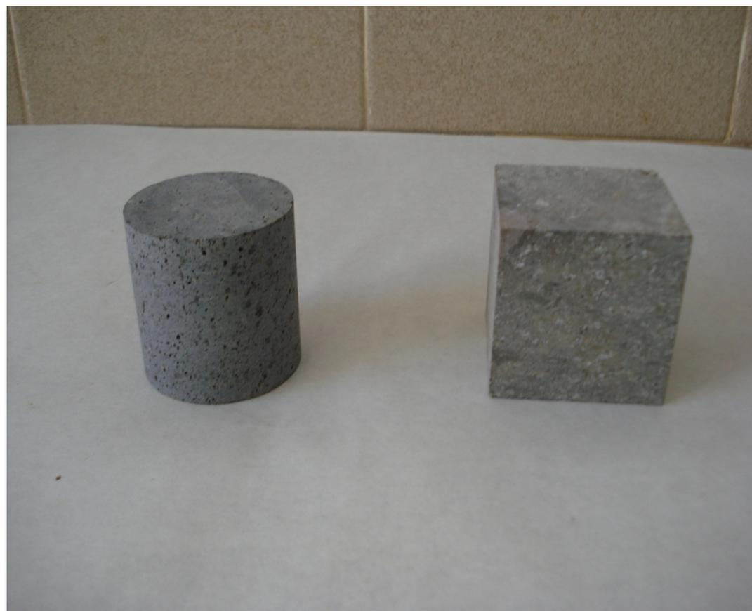
Las probetas deben ser cubos o cilindros de 70 o 50 mm de lado o diámetro.
