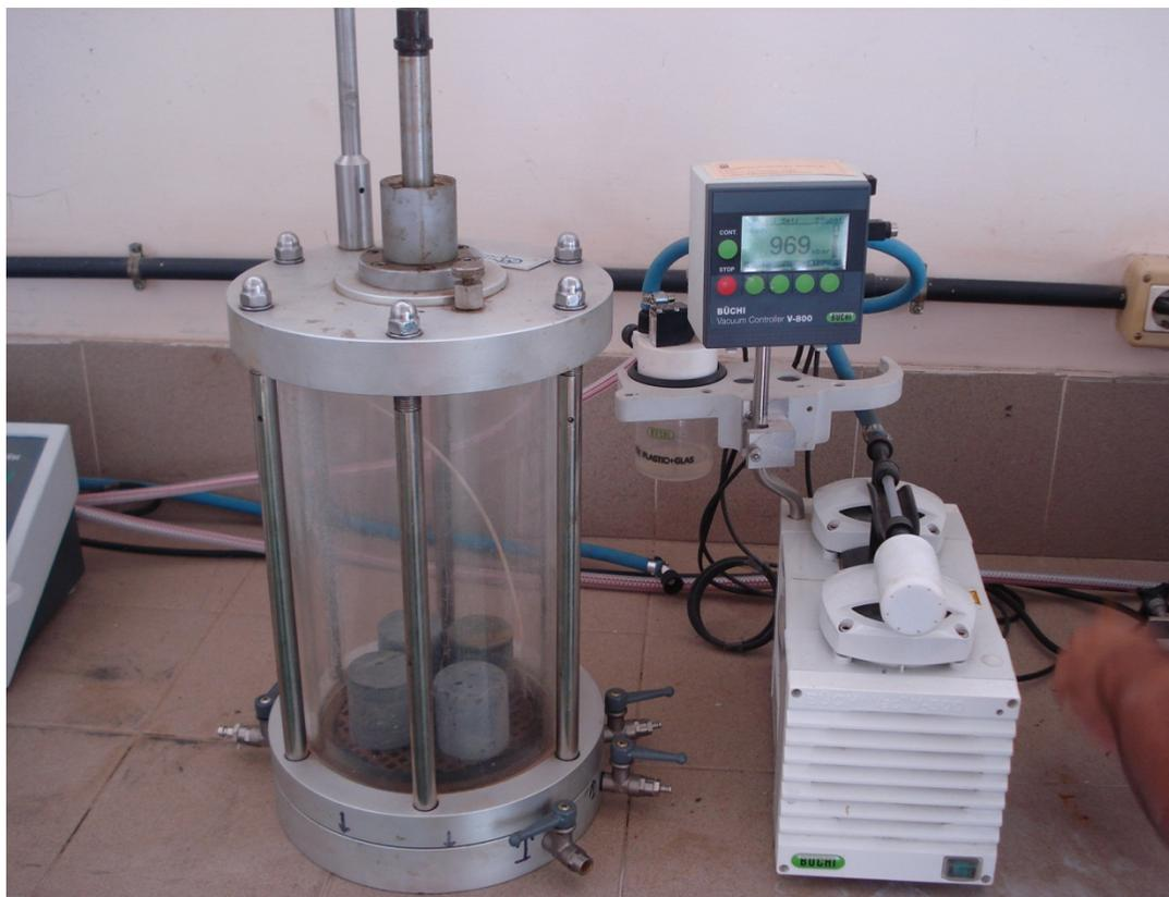
Se colocan las probetas en el recipiente de vacío y se disminuye la presión hasta 2 kPa durante 2 horas.
