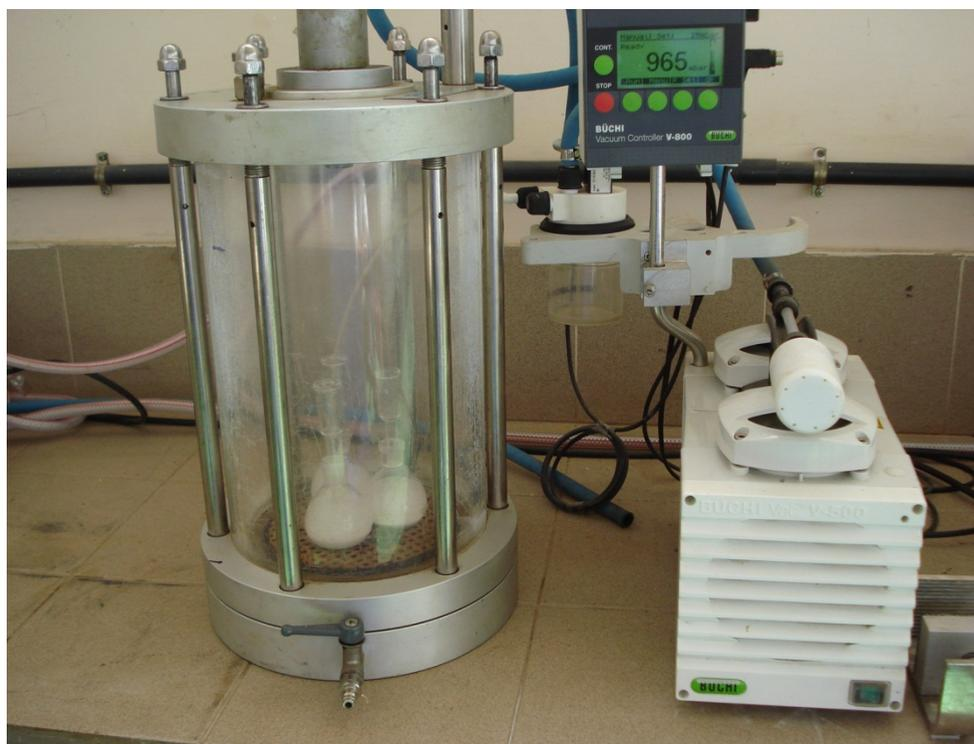
Se somete el picnómetro a vacío (2 kPa) para eliminar las burbujas de aire.
