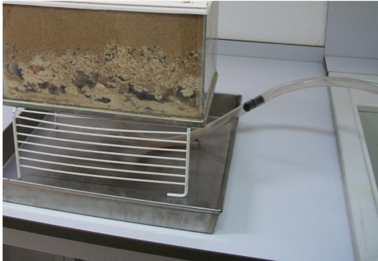
Se abre el grifo del agua para que fluya a velocidad constante creando un flujo ascendente.
