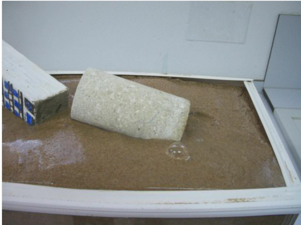
El sifonamiento hace que las tensiones efectivas se anulen ( $\sigma' = 0$ ) perdiendo el terreno toda su capacidad de soporte y produciendo el colapso de las estructuras construidas sobre el mismo.
