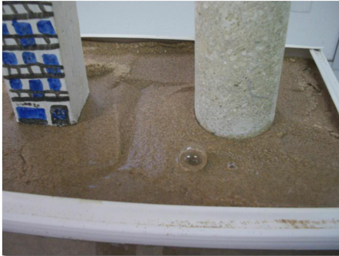
En aquellos puntos del terreno en los que  $\sigma = u$  se produce el sifonamiento de las arenas. El terreno empieza a “ebullir” en zonas localizadas.
