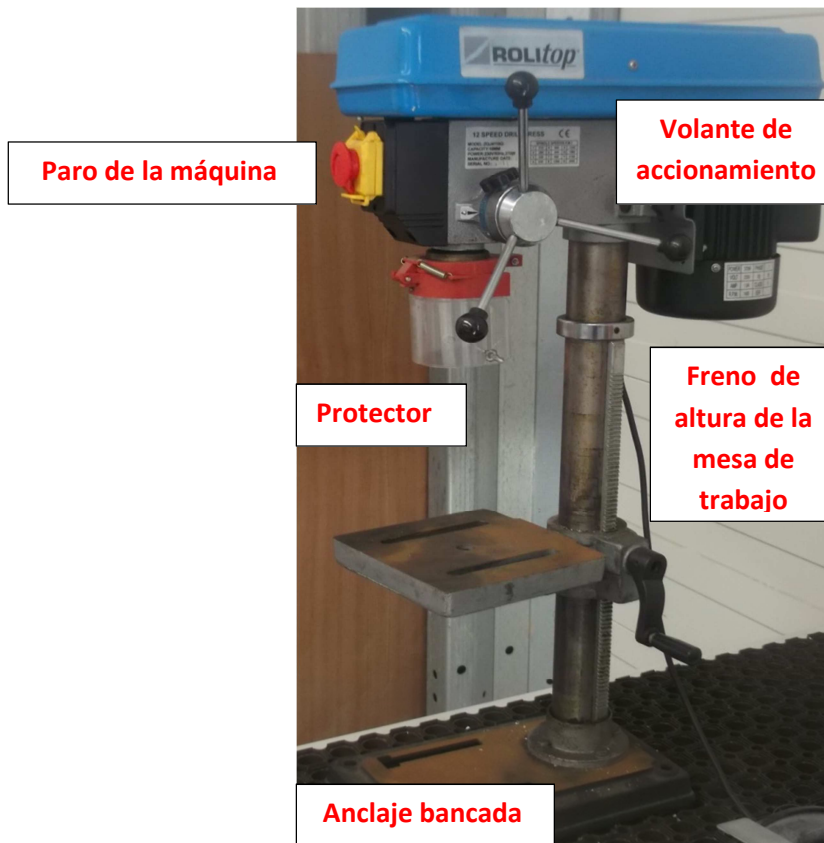
Ilustración nº 2: Partes de la máquina herramienta. Vista lateral.
