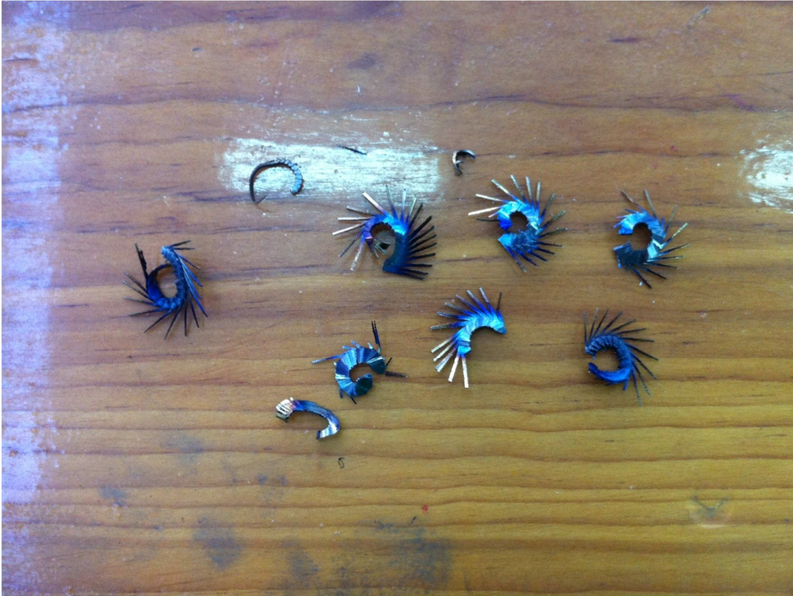
Ilustración nº 13: Arranque de viruta característica de la máquina - herramienta.
