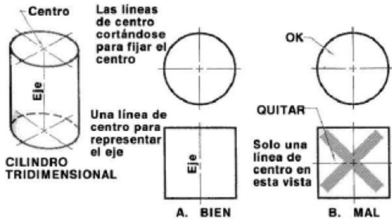
Fig.14 Las líneas de centro identifican los centros de los círculos y los ejes de los cilindros. Las líneas de centro se cortan solo en la vista circular y se extienden aprox. 2mm más allá del contorno exterior.
