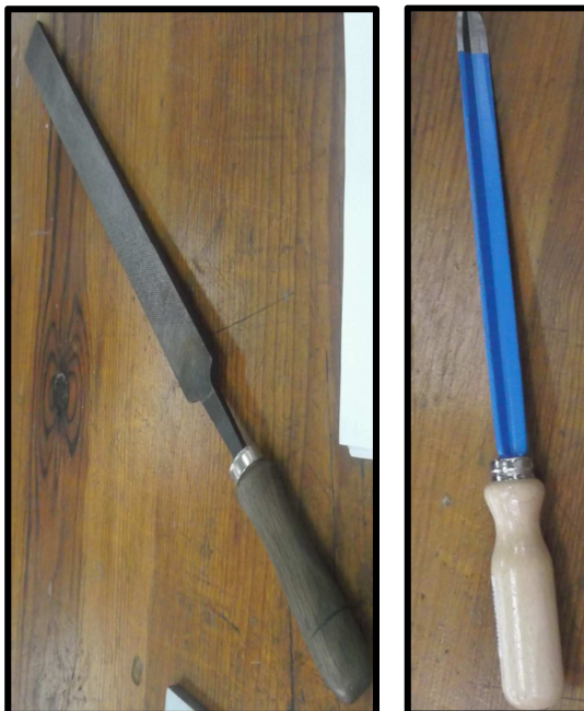
Ilustración n° 4: Vista comparativa entre una Lima y una Rasqueta.
