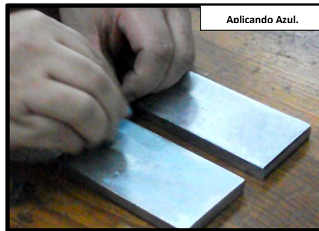
Ilustración nº 11: Trabajo de las dos pletinas.
