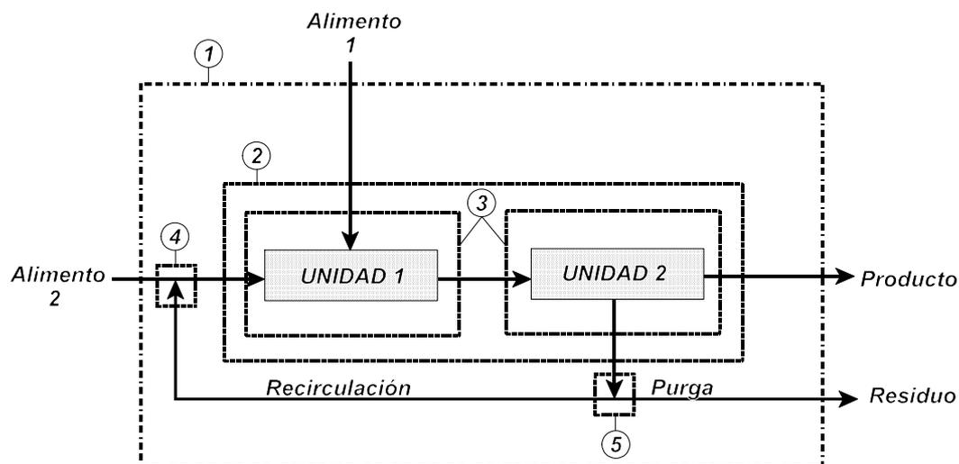
Figura 3.2: Diagrama de flujo para balances de materia.
