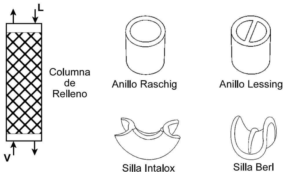
Figura 6.2: Contacto continuo en columna de relleno.
