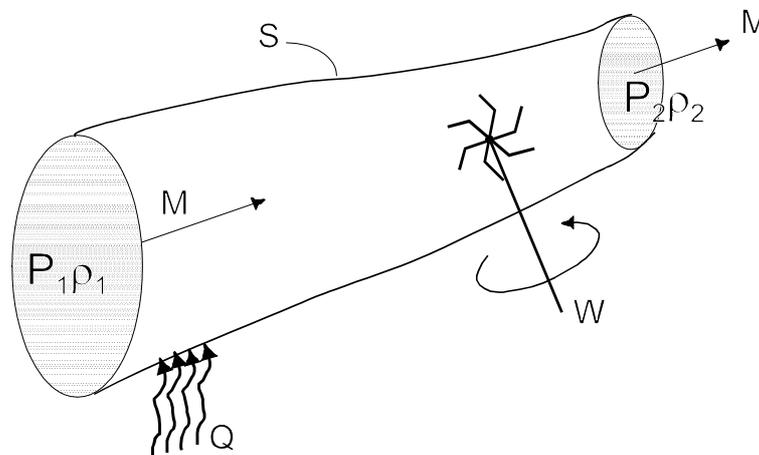
**Figura 4.1:** Elemento macroscópico de fluido.
