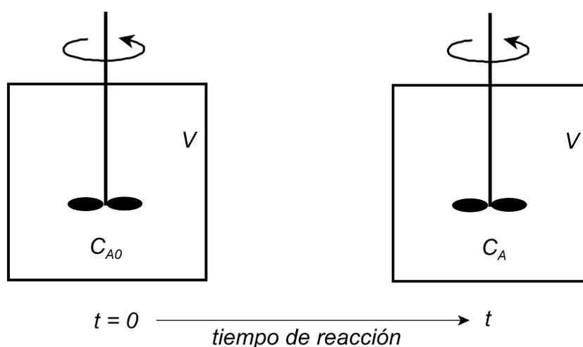
**Figura 5.2:** Reactor discontinuo.
