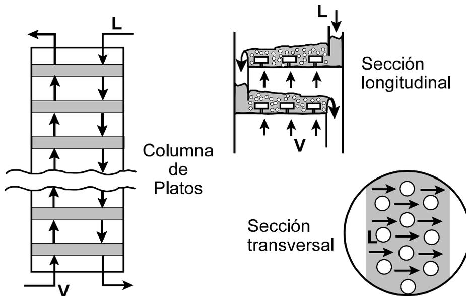
Figura 6.3: Contacto intermitente en columna de platos.
