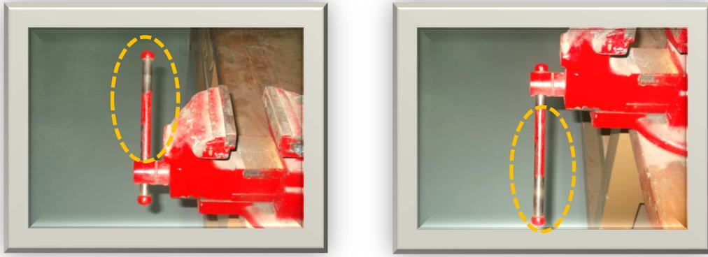
Ilustración nº 4: **Palanca o husillo** de accionamiento abajo y arriba.
