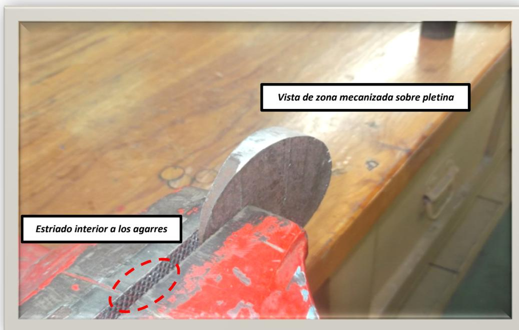
Ilustración n° 14: Vista de acción de mecanizado en **pletina** con herramientas manuales.
