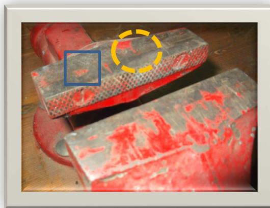
Ilustración nº 13: Vista de **estriado**. Caso particular de **mordaza intercambiable**.
