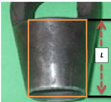
Ilustración nº 11: Pérdida de altura debido a los sucesivos afilados.
