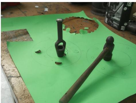
junta de la cual la vamos a realizar para quedar marcada la junta en su forma con los aligeramientos. Puede ser cartón, goma, etc. Nosotros a nivel didáctico la realizaremos sobre papel de cartulina como se puede observar en la ilustración adjunta pero es obvio que no es material de junta de estanqueidad.
