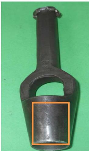
Ilustración nº 10: Sección constante de la zona de corte.
