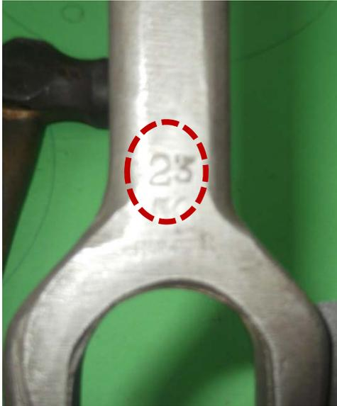
Los sacabocados y dependiendo del tamaño del aligeramiento a fabricar vienen de distintas **medidas**. Las medidas corresponden al diámetro de la zona de corte. La zona de corte es la parte cortante y debe de estar bien afilada. Siempre el numero viene marcado sobre el material del sacabocado y en su parte frontal, tal y como se puede observar en la ilustración adjunta.
