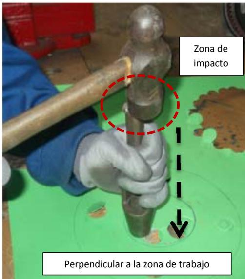
sobre el aligeramiento tal y como se muestra en la ilustración adjunta. Es necesario pues y una vez presentado el sacabocado al sitio el impacto del mismo con un **martillo metálico** por la zona de golpe. Para ello el sacabocado tiene que estar bien sujeto, perpendicular al material de la junta y toda la superficie de corte en perfecto contacto con el material de la junta. *Recomendable* colocar una material debajo de la junta para no dañar la mesa de trabajo en la operación descrita.
