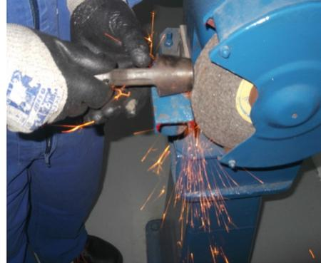
Ilustración nº 12: Superficie de corte/sacabocado/mellado. Inicio afilado.
