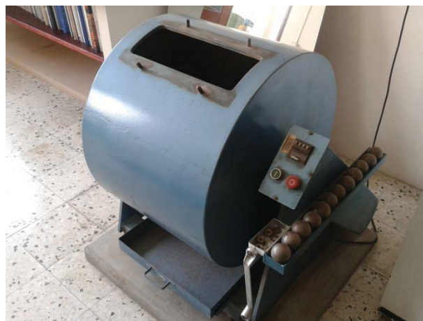
Figura. Máquina para la realización del ensayo de Los Ángeles (medidas en mm) [1]
