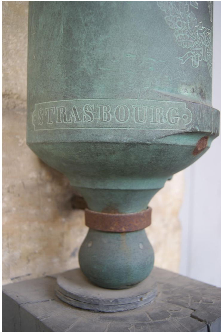
F. 12: Ilustración de corrosión galvánica. Sistema de sujeción hierro-bronce susceptible de este tipo de corrosión.
