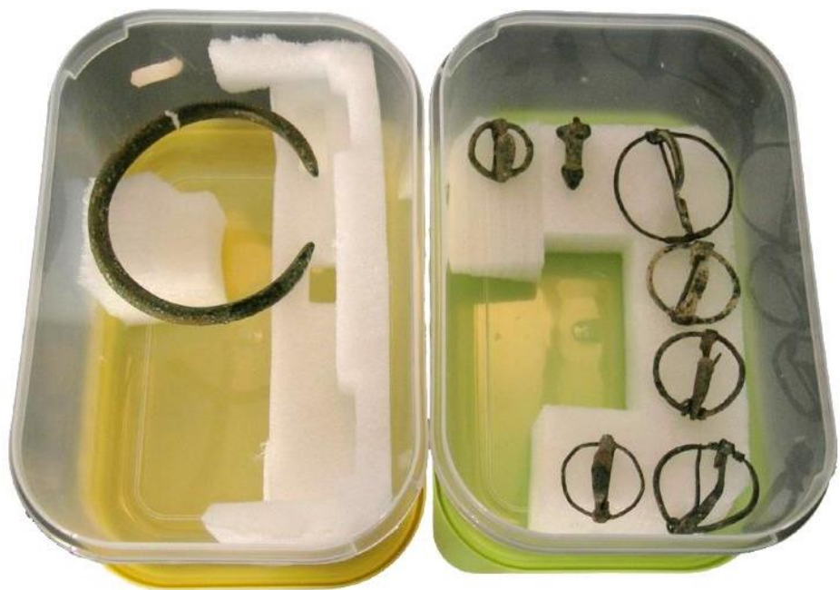
F. 24: Piezas procedentes de la colección Llamazares. Museo de Ronda. Estas piezas van a ser sometidas a la cámara de humedad. Transcurridas 24-48 H., se podrá observar los focos de cloruros activos.
