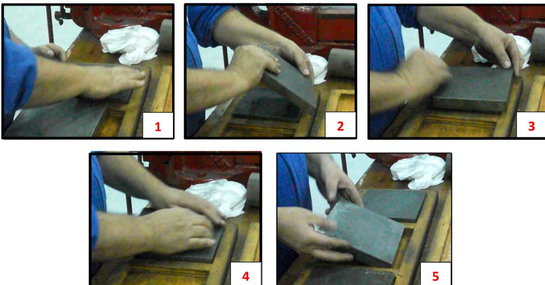
Ilustración nº 22: Procedimiento de reconstrucción de caras de mármoles de trabajo.
