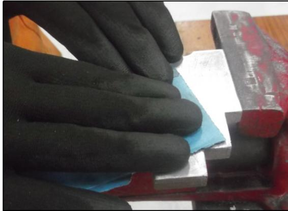
Ilustración nº 26: Vista de papel de lija en ejecución de trabajo manual. Recomendable utilizar EPI en el lijado.
