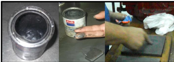
Ilustración nº 11: Pasta de esmeril aplicación sobre primer mármol de desbaste.
