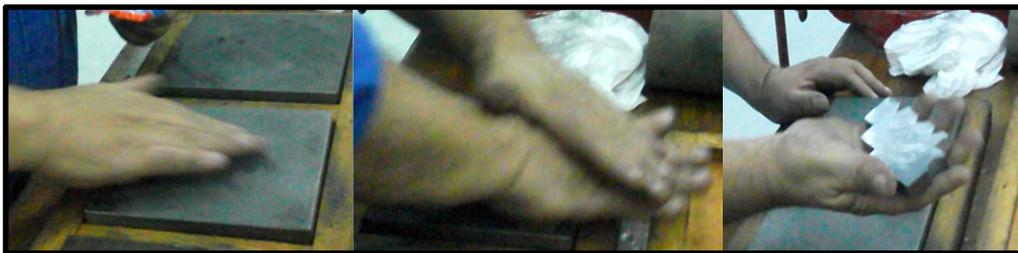
**Ilustración nº 14: Aplicación pasta de esmeril de grano grueso sobre mármol de acabado final. Operación de esmerilado. Producto final.**
