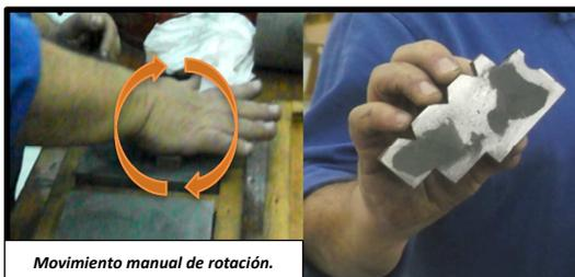
Ilustración nº 12: Mecanizado con consumible manual sobre útil.
