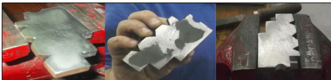
Ilustración nº 16: Producto final. Pletina totalmente brillante y en plano después de lijado y esmerilado.
