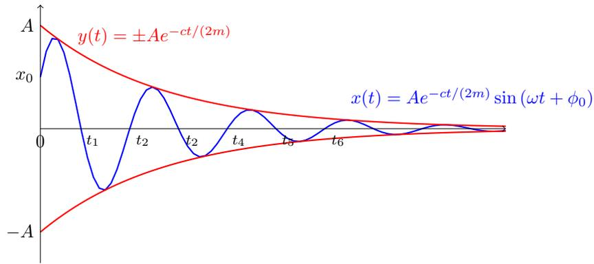
Si  $c^2 \ll 4mk$ , la solución refleja un movimiento casi armónico en la que la amplitud permanece prácticamente constante. En este caso se puede pensar en despreciarla siempre que el cociente  $c^2/(4mk)$  sea suficientemente pequeño. En términos prácticos, se puede demostrar que si  $c^2/(4mk) \lesssim 0.00006$  se garantiza que después de un período la masa vuelve a su posición original al menos en un 95%, por lo que la fricción se considera despreciable.
