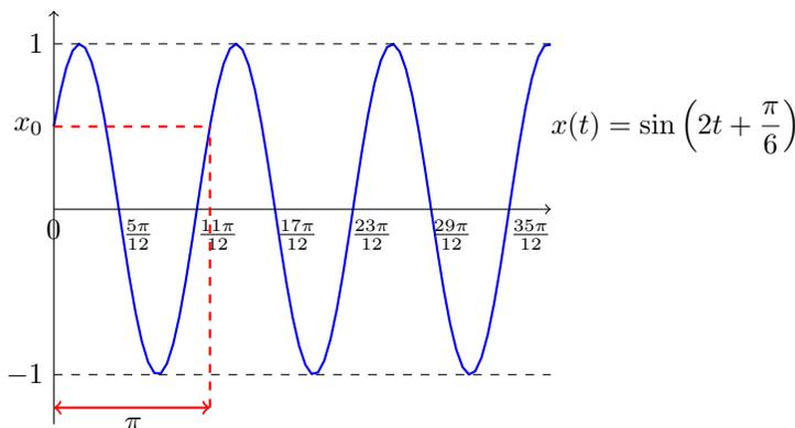
Esta solución nos dice que el sistema masa-resorte arranca con velocidad  $v_0$  m/s alejándose del punto de equilibrio en la dirección positiva hasta llegar a una distancia máxima  $x = 1$ . En ese momento, empieza a acercarse de nuevo al punto de equilibrio que alcanza en  $t = 5\pi/12$  segundos y luego sigue alejándose en la otra dirección hasta llegar a otro punto de máximo alejamiento  $x = -1$ . Y luego vuelve, oscilando eternamente.
