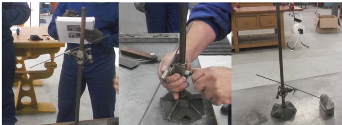
Ilustración nº9: Manipulación de la altura de la punta de trazar. Fuente: Trabajo de campo.
