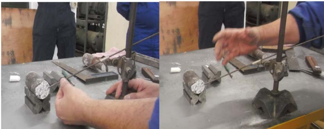
Ilustración nº10: Marcando la pieza después de acotar. Fuente: Trabajo de campo.
