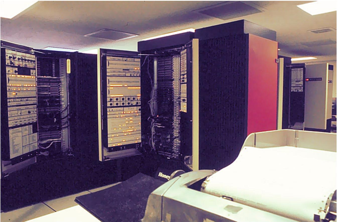
Figura 10. Mainframe GE-6180 con sistema MULTICS, en torno a 1976 en el MIT — Fuente: [Multicians](#)
