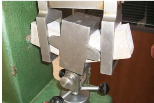
Figura. Rotura a flexión
