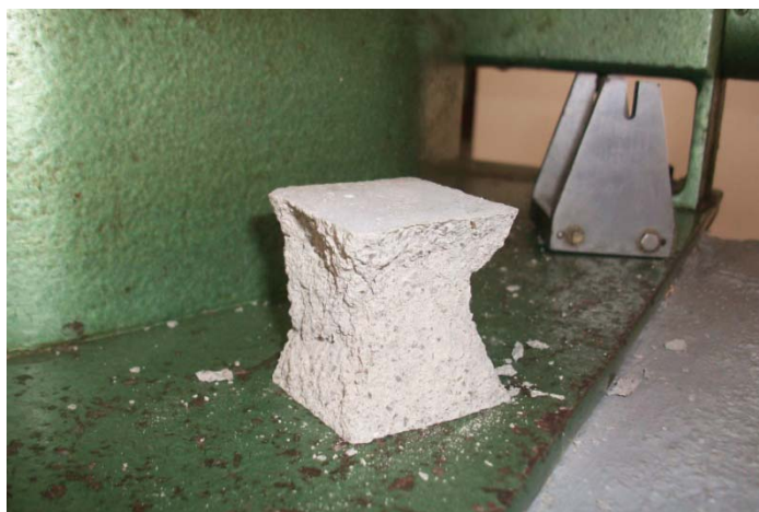
Figura. Rotura a compresión
