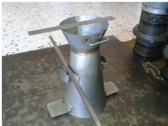
*Figura. Cono de Abrams, tolva de llenado, bandeja de base, regla graduada y barra compactadora*
