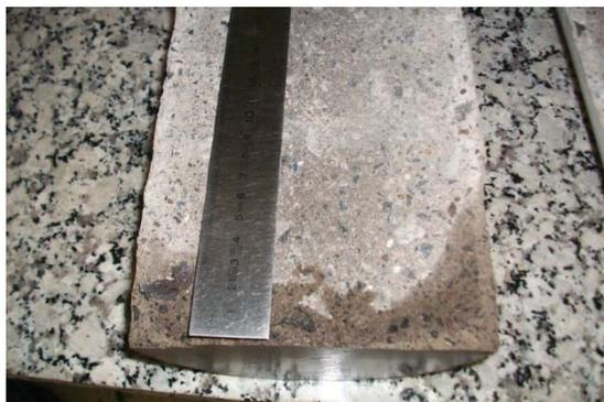
*Figura. Penetración de agua bajo presión*
