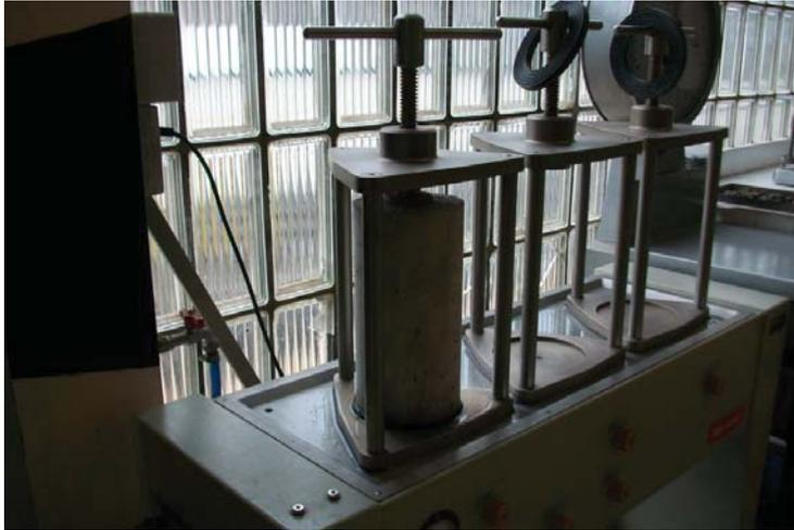
Figura. Equipo para el ensayo de penetración de agua bajo presión
