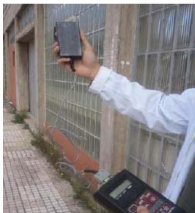
*Figura. Pachómetro en el momento de encendido [2]*
