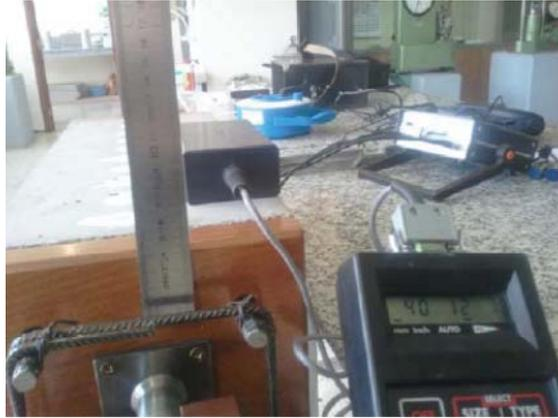
**Figura.** Comprobación de la medida de recubrimiento [2]
