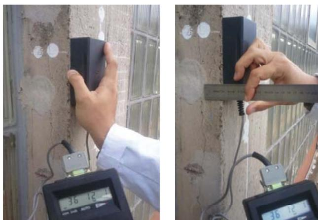
*Figura. Pachómetro usado para la determinación del espesor de recubrimiento de hormigón [2]*
