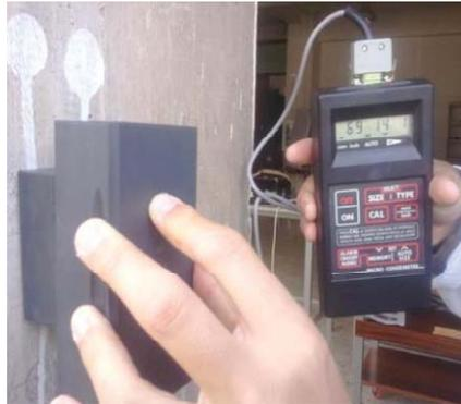
Figura. Pachómetro usado para la determinación del diámetro de la armadura [2]
