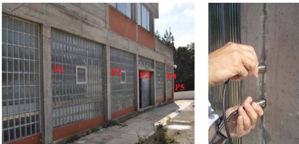
Figura. Medida en pilar (transmisión indirecta, [2])
