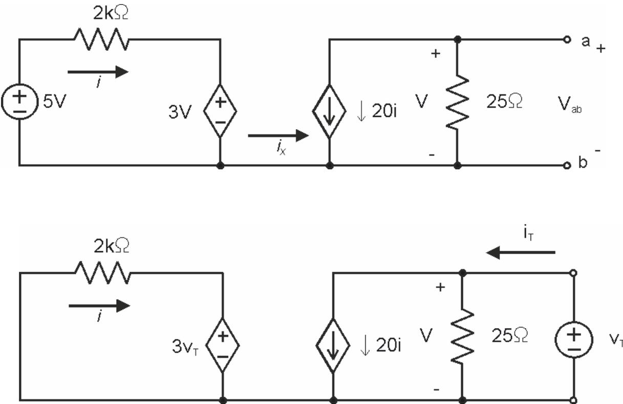
Primero desactivamos la fuente de tensión independiente del circuito y luego excitamos el circuito desde los terminales  $a$  y  $b$  con una fuente de tensión de prueba o con una fuente de corriente de prueba.
