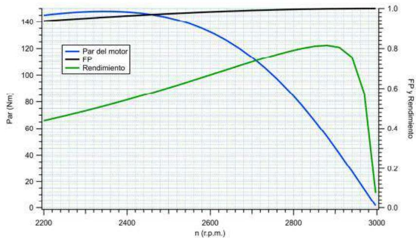
Este motor se conecta a una red trifásica de 400 V y 50 Hz. Determina:
