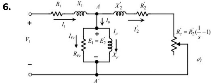
La resistencia de carga en el circuito equivalente de un motor asíncrono
