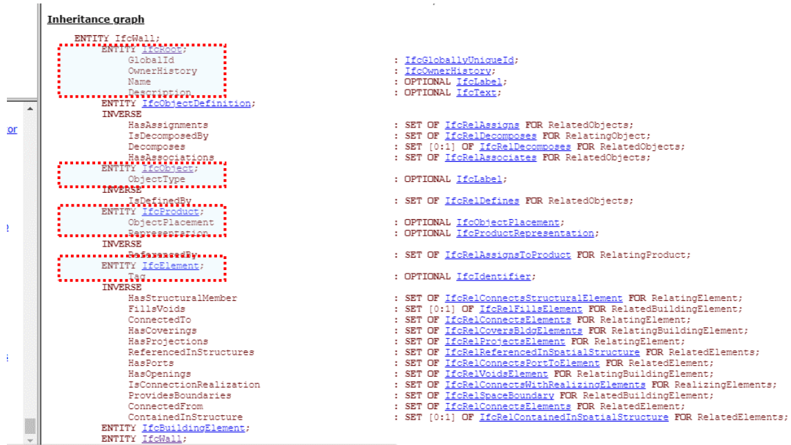
Figura 15. Atributos de las Entidades IfcWall en la web oficial del esquema 8
