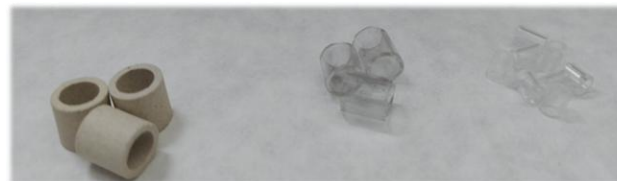
Anillos Raschig de diferentes materiales y tamaños
