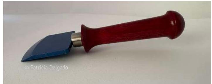
La herramienta está realizada en acero con un borde curvo dentado muy cortante, con un número de dientes concentrados en diferentes distancias y grosores que puede variar dependiendo del tamaño de la herramienta.
