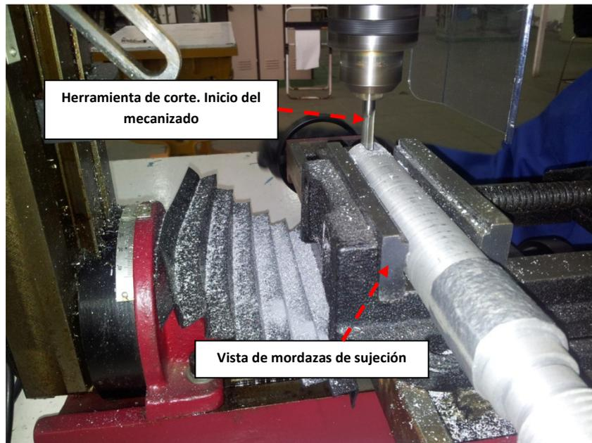
Ilustración nº 5: Inicio del mecanizado por arranque de viruta. Fresado vertical
