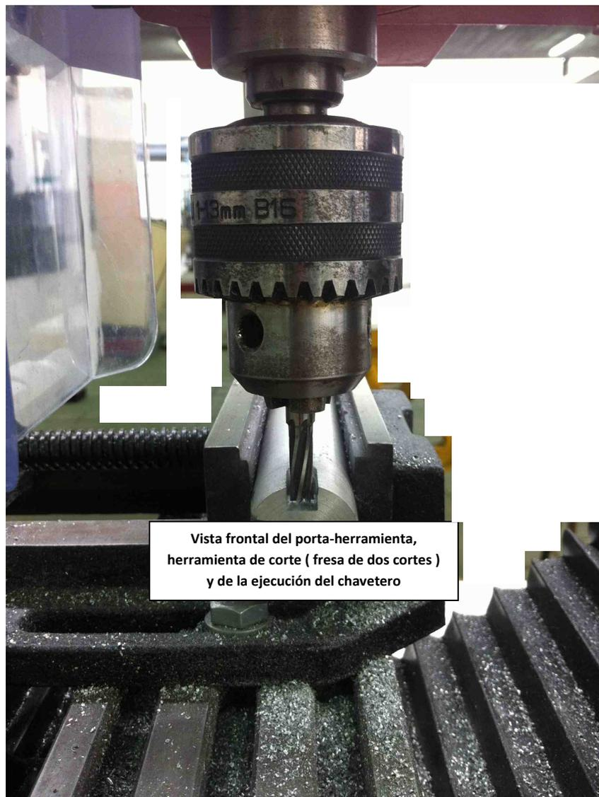
Ilustración nº 9: Vista frontal de los elementos que actúan en el mecanizado y producto final
