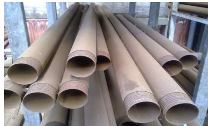
Tubería de Revestimiento
