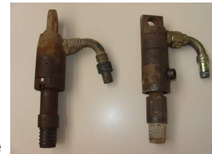
Giratoria de inyección
