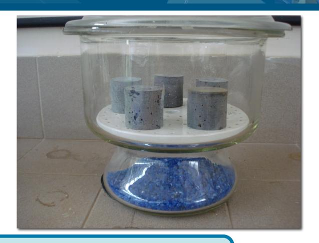
Tras el secado en estufa, se colocan en un desecador hasta alcanzar temperatura ambiente.
