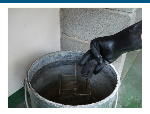
Se pesan las muestras bajo el agua en balanza hidrostática y se anota su masa  $(\mathbf{m_h})$ .
