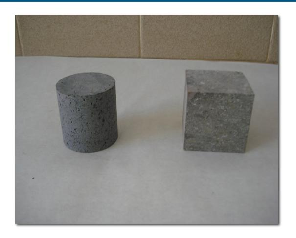
Las probetas deben ser cubos o cilindros de 70 o 50 mm. Se dispondrá al menos de 6 probetas por muestra a ensayar.
