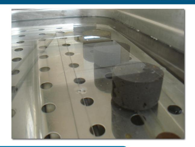
Cada 24 h se sacan y se pesan las probetas hasta conseguir masa constante finalizando así el ensayo para la determinación de la porosidad abierta y densidad aparente.
