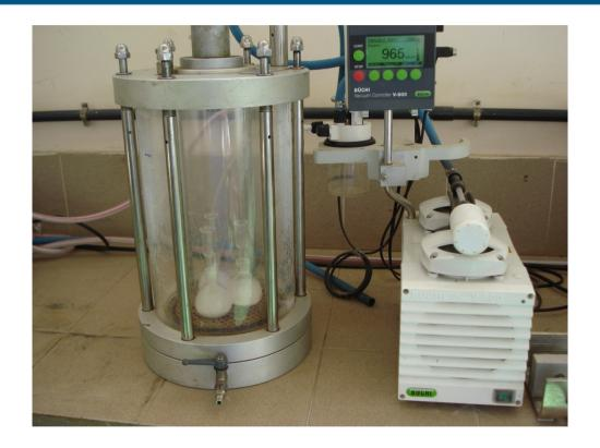
Se somete el picnómetro a vacío (2 kPa) para eliminar las burbujas de aire.
