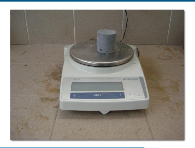
Se extraen las probetas del desecador y se obtiene su masa por pesado en balanza ( $\mathbf{m}_{\mathrm{d}}$ ).
