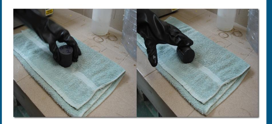
Se secan superficialmente de forma rápida con un trapo húmedo
