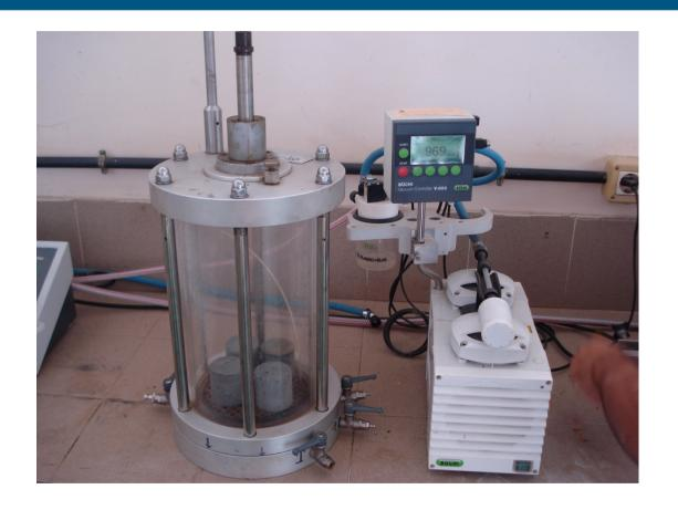
Se colocan las probetas en el recipiente de vacío y se disminuye la presión hasta 2 kPa durante 2 horas.
