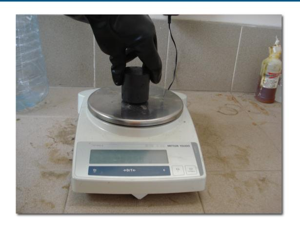
Se anota la masa saturada de las probetas  $(\mathbf{m_s})$
