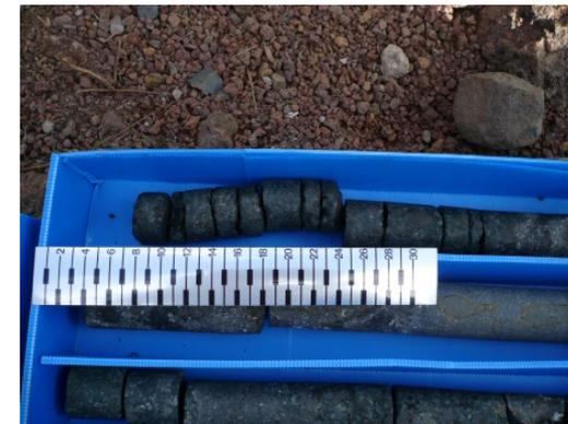
Se ha de indicar, con una marca perpendicular al eje de los testigos, el inicio y fin de cada maniobra
